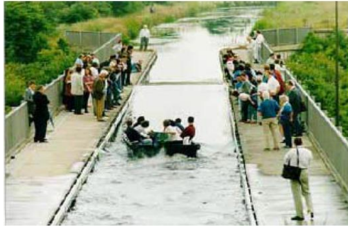
Figure III.1. Reproduction en 1995 et au même endroit de la première observation d'un soliton. Sans l'action non linéaire, une onde hydrodynamique isolée devrait s'étaler sur une très courte distance de propagation. Ici, le bateau génère l'onde au-devant de sa proue, laquelle devient une entité indépendante : un soliton [8].
