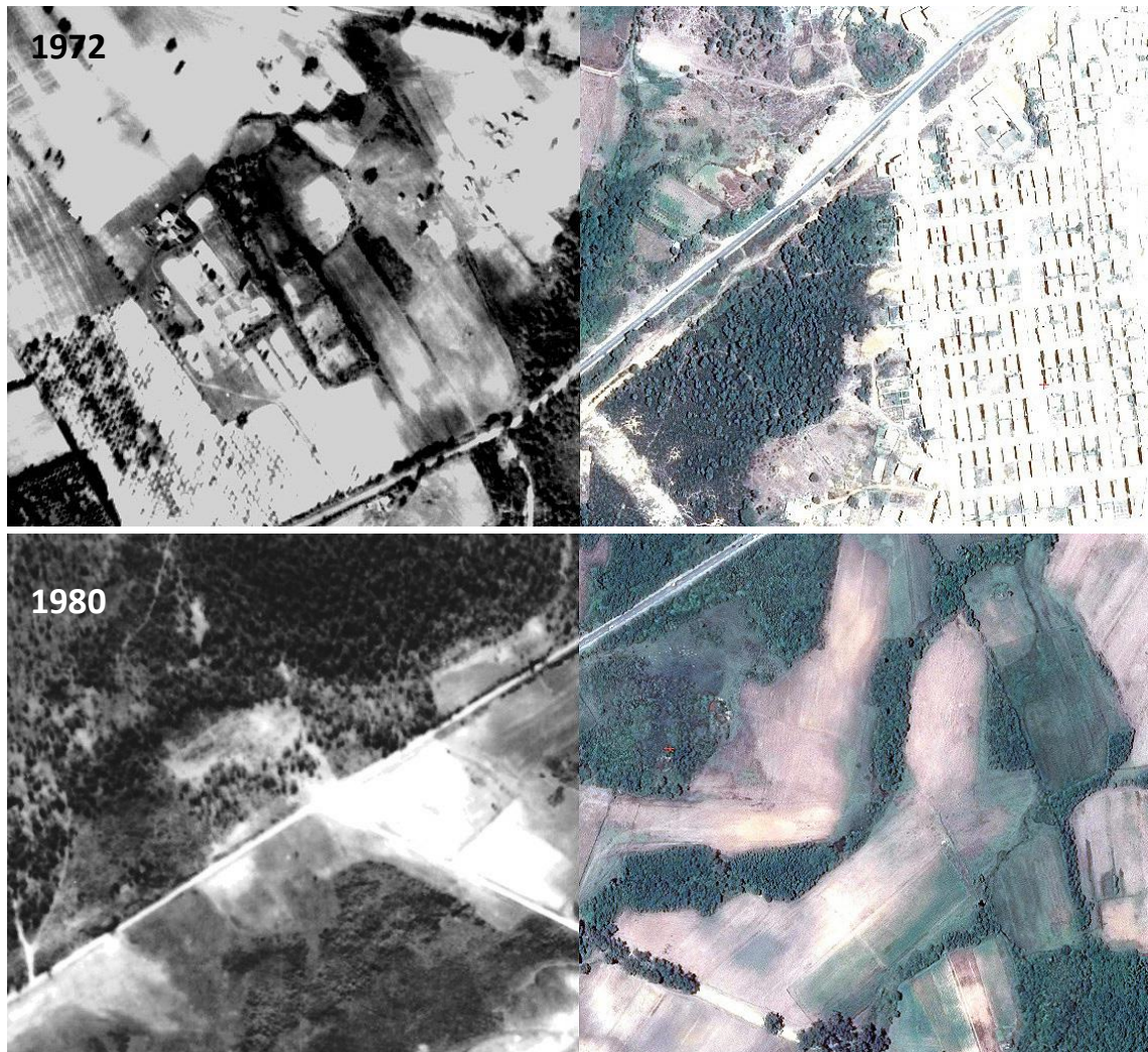
Figure 50. Validation de l'orthorectification (à droite, l'image Google Earth comme référence ; à gauche, l'orthophoto à vérifier)
