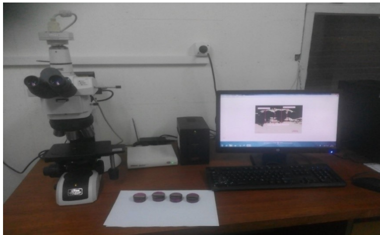
Figure II.4 : Microscope optique à réflexion Nikon éclipse LV1500N
