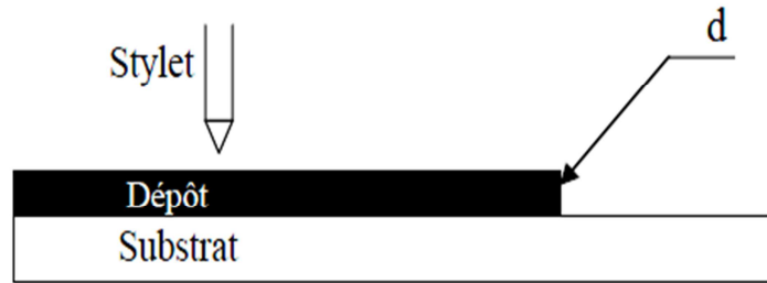
Figure.II.16: Principe de mesure de l'épaisseur par un profilomètre Dektak.
