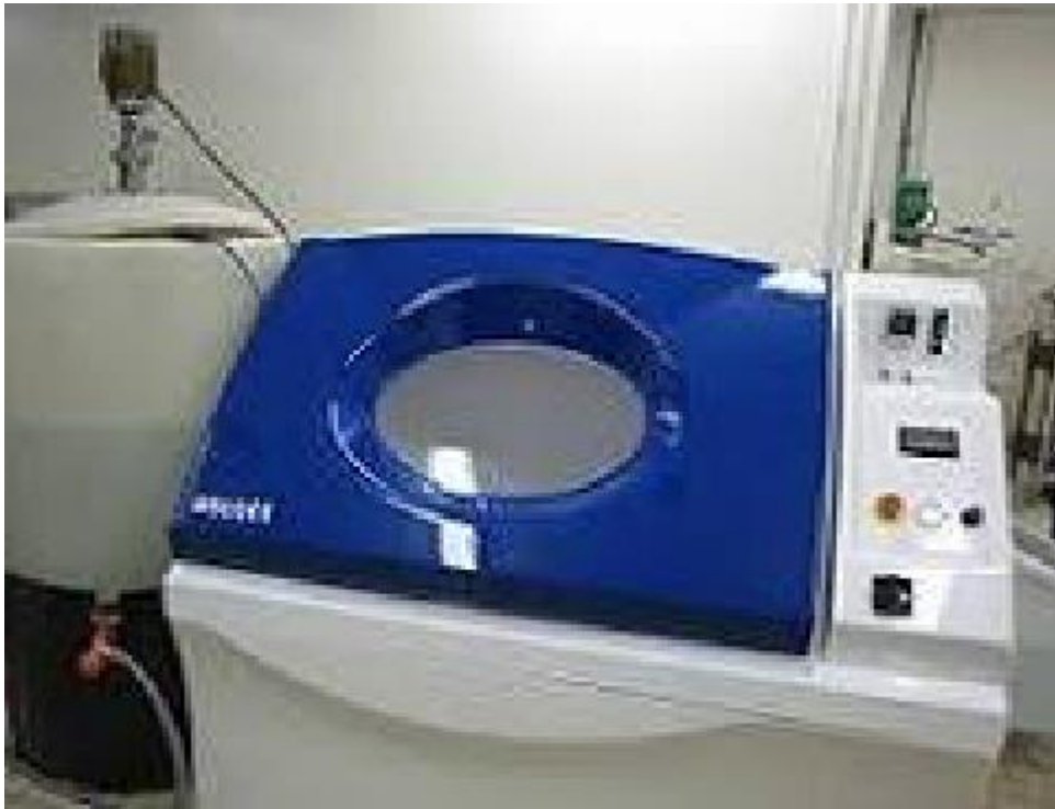
Figure II.8 Schéma d'une enceinte climatique de brouillard salin
