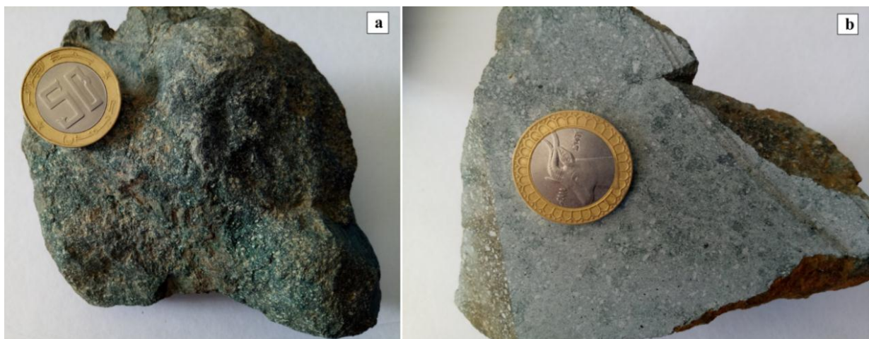
Fig. III.10. Aspect macroscopique des dacites d'El Aouana. a) aspect massive des dacites ; b) dacite de couleur verdâtre due à la présence des minéraux d'altération.
