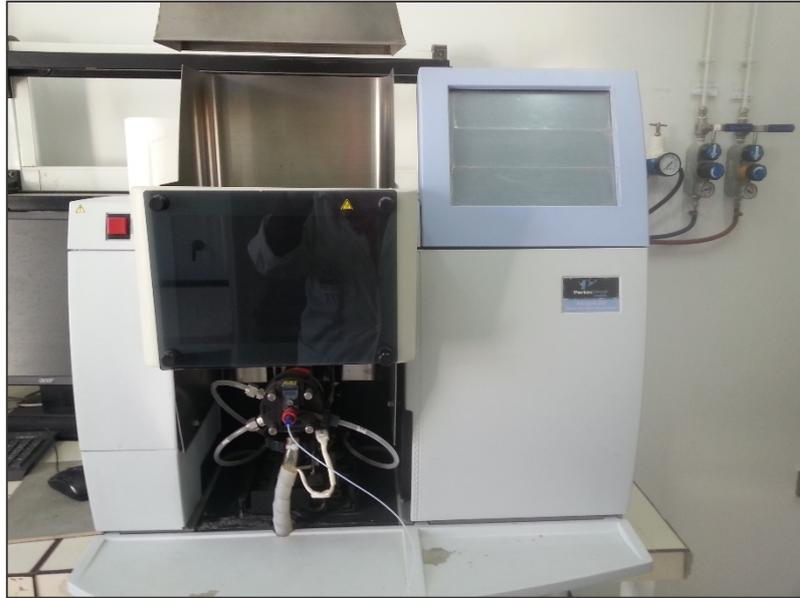
**Figure 15 :** Spectrophotomètre d'absorption atomique : Perkin Elmer AAnalyst 200
