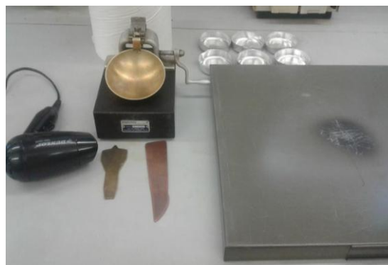
Fig.181 : Le dispositif de l'appareil de Casagrande
