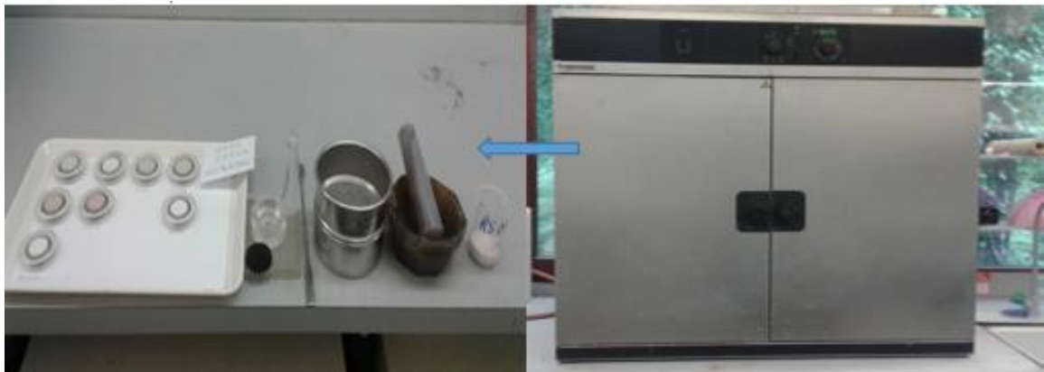
Fig.91 : Préparation de la poudre pour la minéralogie totale
