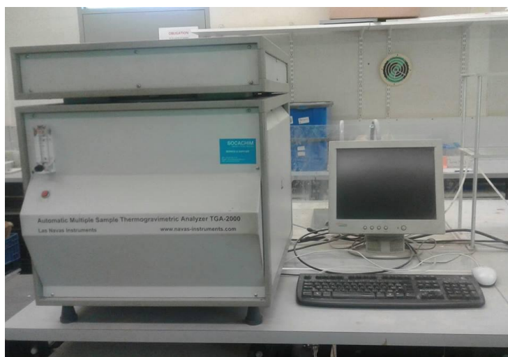
Fig.155 : Photo de l'appareil thermogravimétrique TGA 2000
