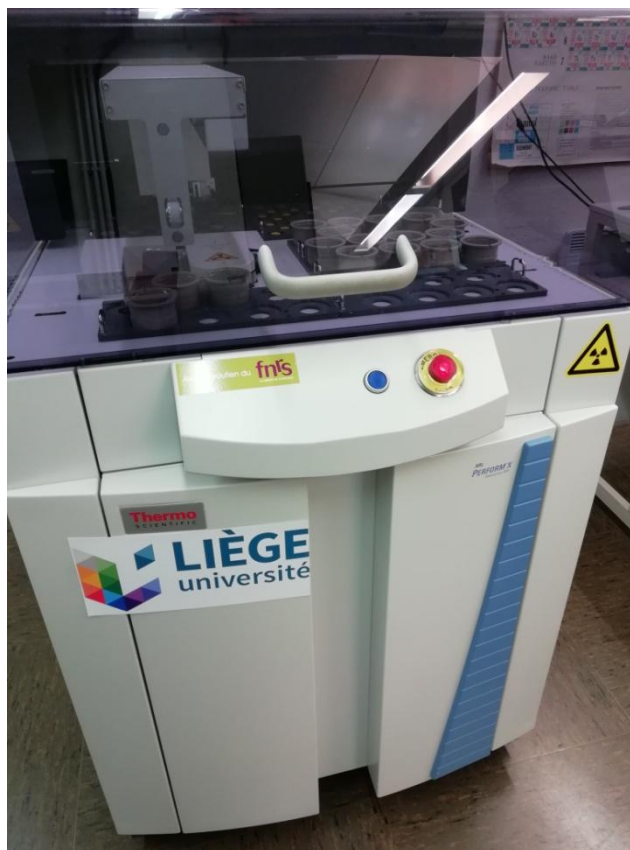
Fig.168 : Le spectromètre ARL, PerformX 9400 (Ulg)
