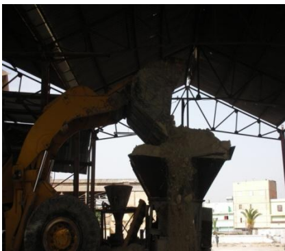
Fig.04: Alimentation du concasseur
