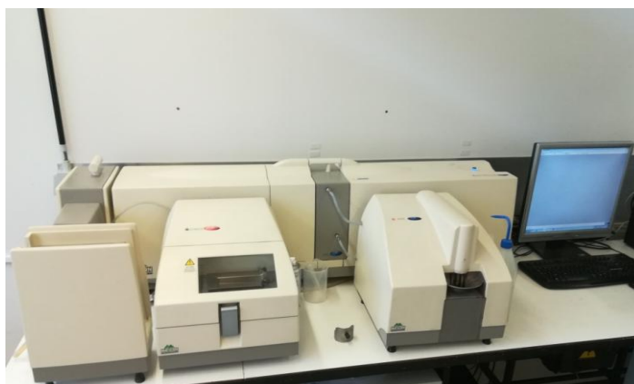
Fig.175: Granulomètre Laser Malvern Mastersizer 2000. (Laboratoire LCIS à Ulg)
