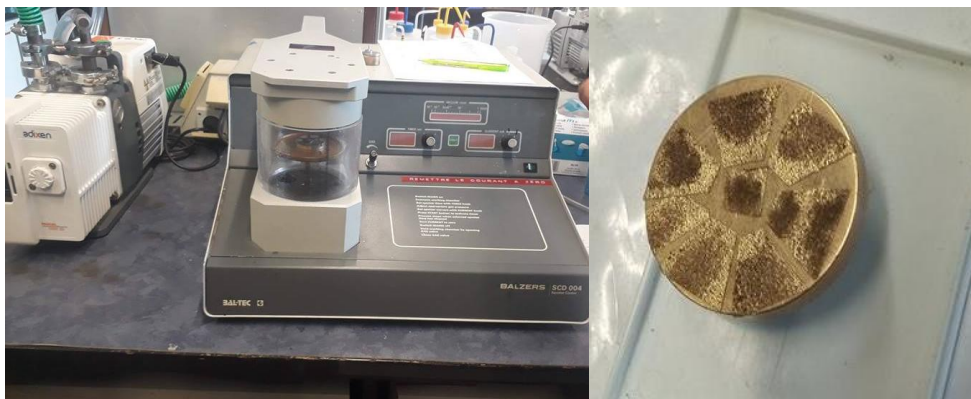
Fig.186: Métallisation des échantillons par l'Or avant le passage au MEB
