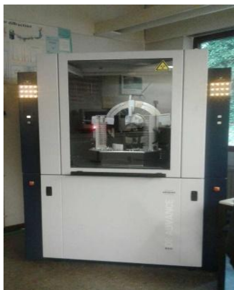
Fig.90 : Diffractomètre de type Brucker D8-Advance du laboratoire AGEs à l'ULG
