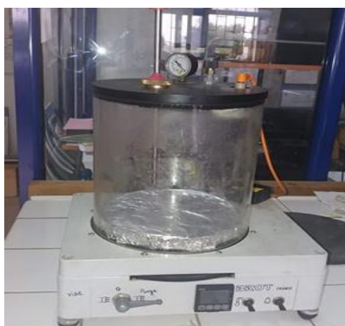
Fig.22 : la sonde d'imprégnation de type BROT utilisée pour l'enrobage
