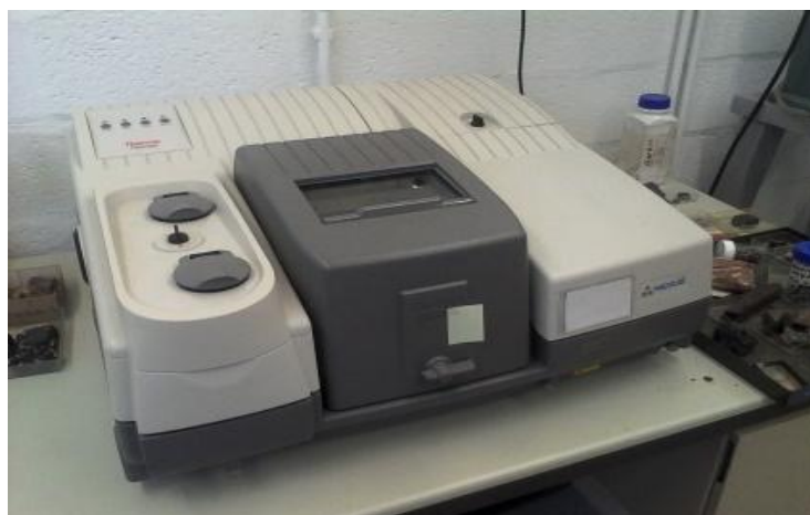
Fig.162 : Spectromètre infrarouge de type Nicolet NEXUS (Laboratoire de minéralogie et cristallographie Ulg)
