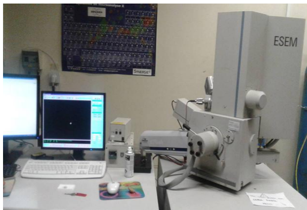
Fig.185 : Le microscope électronique à balayage de type FEG-ESEM XL30
