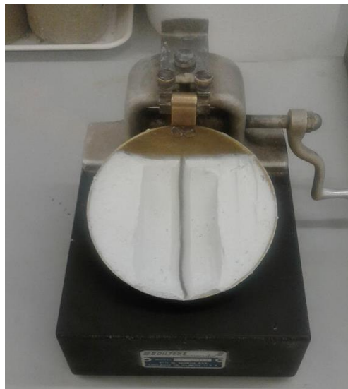
Fig.182 : Le principe de calcul de la limite de liquidité à l'aide de l'appareil de Casagrande
