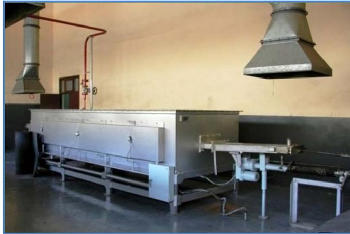
**Figure III-1.** Four de réduction des oxydes à l'échelle industriel avec trois paliers de températures (Eris Batna).
