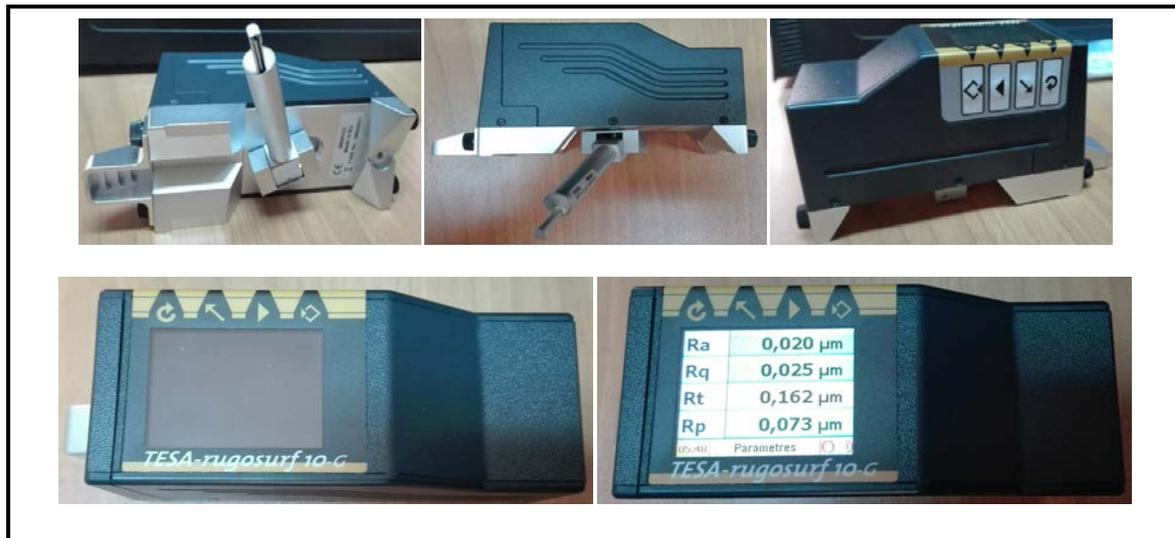
**Figure III-18.** Rugosimètre utilisé pour mesurer le relief de la surface des échantillons en acier élaboré avant et après nitrocarburation.
