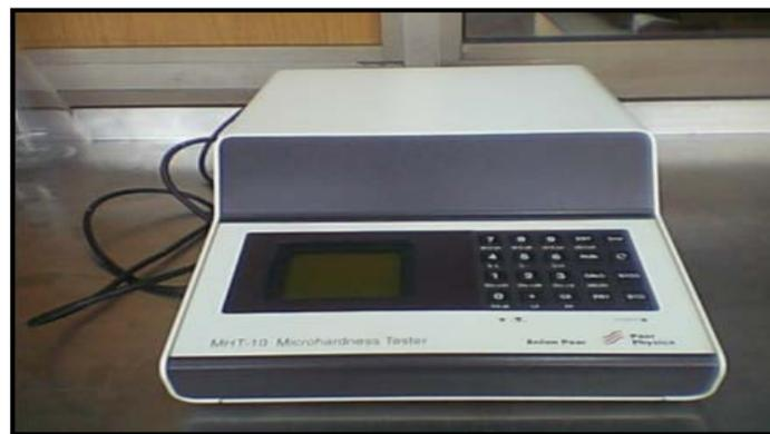
**Figure III-29.** Micro-duromètre utilisé pour les essais de micro-dureté Vickers (ALGER).
