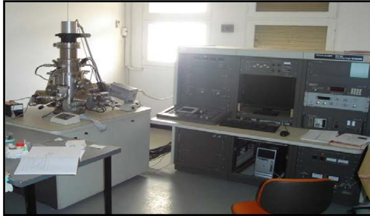
*Figure III-26. Spectroscopie d'électrons Auger - multisonde à balayage Auger (PHI-600) (ALGER).*
