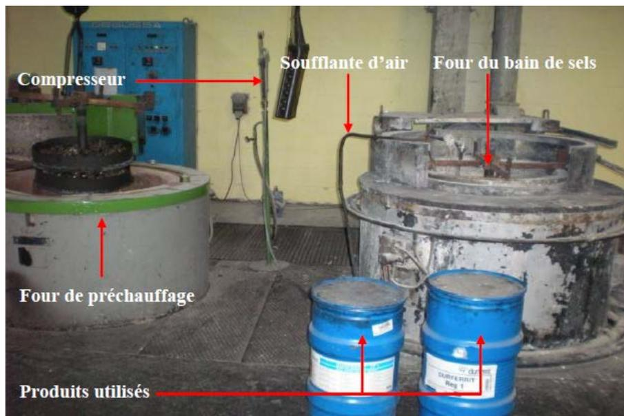
**Figure III-17.** Installation utilisée pour le traitement thermochimique de nitrocarburation en bain de sels (Complexe Moteurs Tracteurs Constantine).
