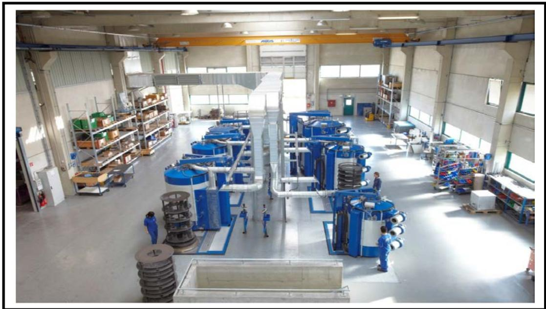
*Figure II-10. Ligne moderne commerciale de nitruration au plasma (avec l'autorisation de Rubig GmbH).*
