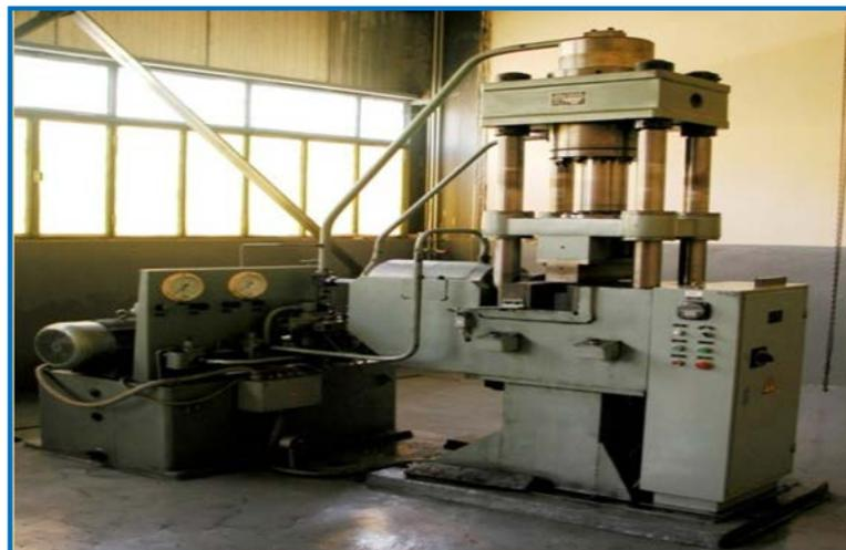
**Figure III-5.** Presse hydraulique de pression nominale 1000 KN Utilisée pour compacter les poudres d'acier (Eris Batna).
