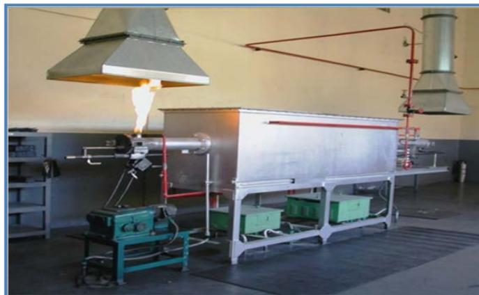
**Figure III-6.** Four utilisé pour le traitement de frittage des compacts d'acier (Eris Batna).
