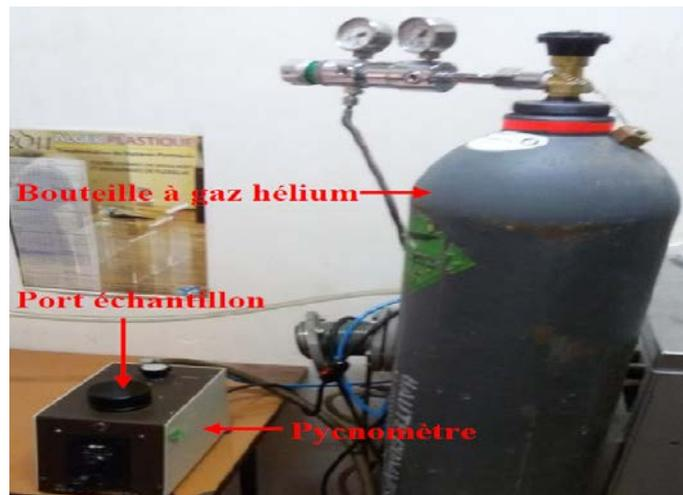
**Figure III-10.** Pycnomètre à hélium de type Micromeritics modèle 1302 pour mesurer la densité (Alger).
