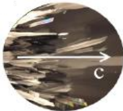
Figure 16: Sous-joints de grain d'un échantillon de saphir découpé d'un lingot cristallisé par la méthode de Verneuil.
