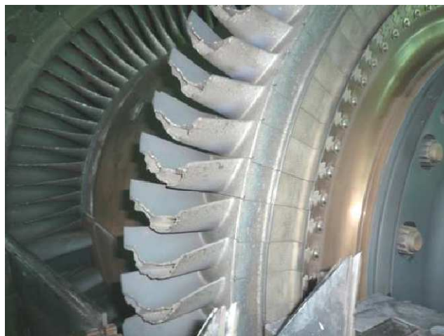
Figure I.1: Usure des aubes d'un compresseur axial [1]
