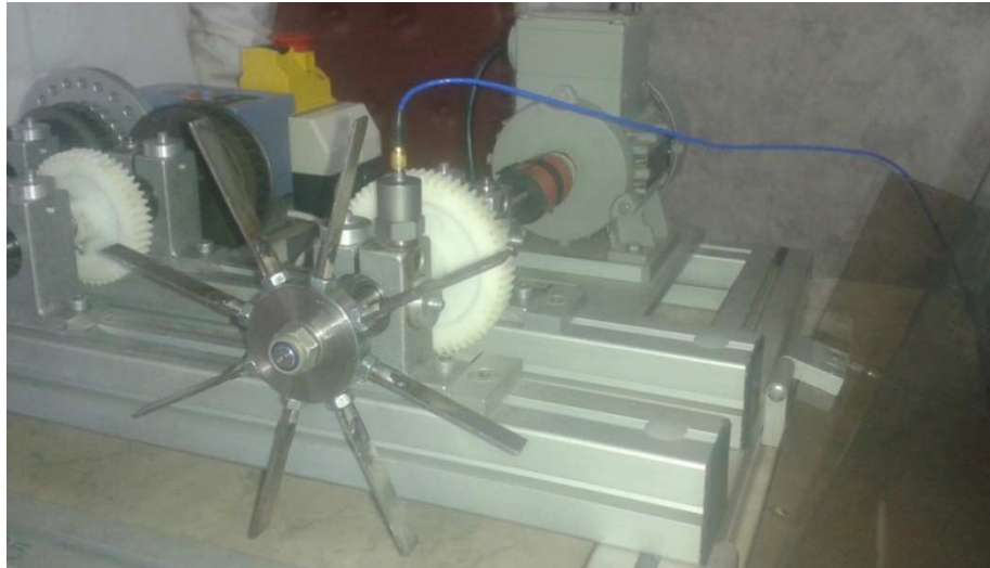
Figure 4.5: La roue aubagée installée sur le banc d'essai
