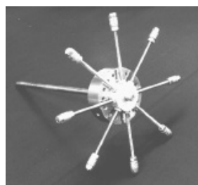
Figure 4.2: Roue aubagée avec des aubes cylindriques [277]
