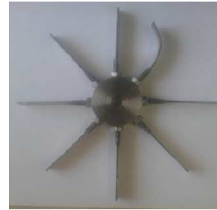
Cas 2 : Roue avec aube déformée
