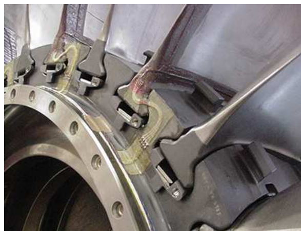
Figure 2.18: Installation typique de jauge de contrainte de rotor [142]
