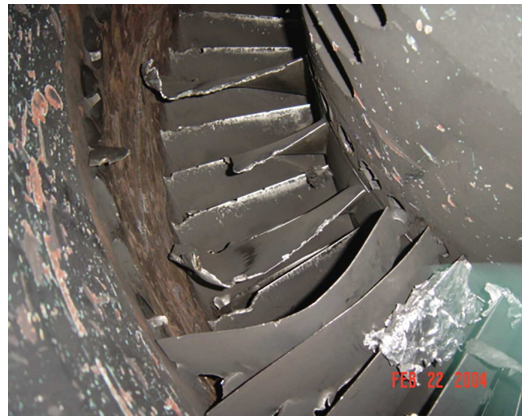
Figure 1.22: Photographie de la déformation des aubes d'un compresseur [12]
