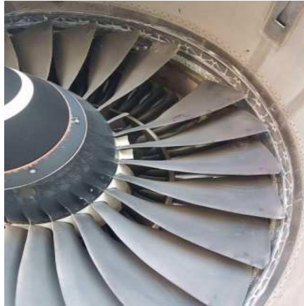
Figure 1.26: Perte d'ailette de soufflante du réacteur d'avion
