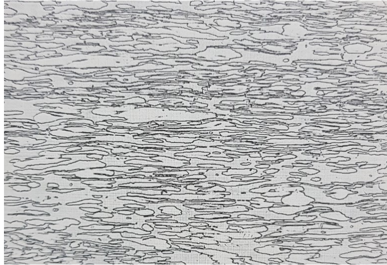
Figure I. 5. Structure austéno-ferritique de l'acier inoxydable [25].
