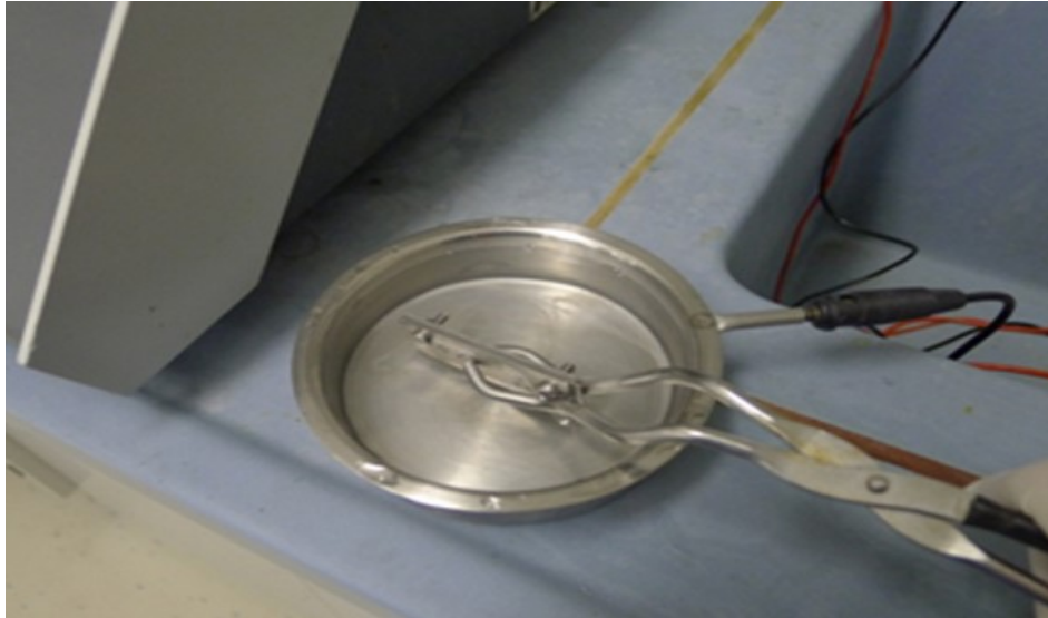
Figure III. 22. Attaque chimique électrolytique.
