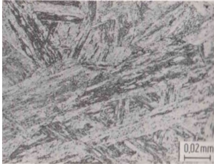
Figure I. 4. Structure martensitique de l'acier inoxydable [25].
