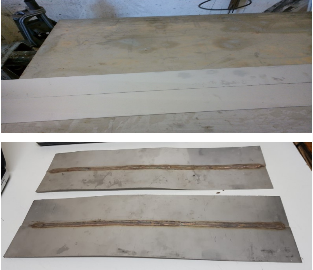
Figure III. 13. Morceaux découpés et soudés bout à bout par TIG.
