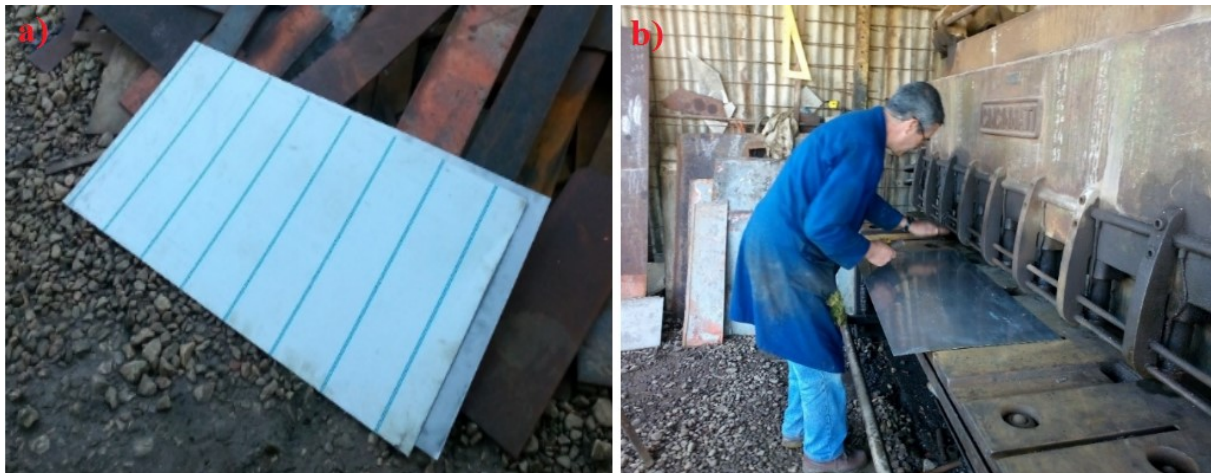
Figure III. 12. Découpage des tôles en acier inoxydable austénitique 304L.
