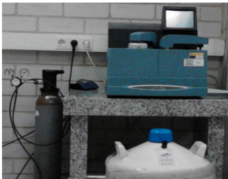
Figure II.11 : Calorimétrie différentielle à balayage Q2000.
