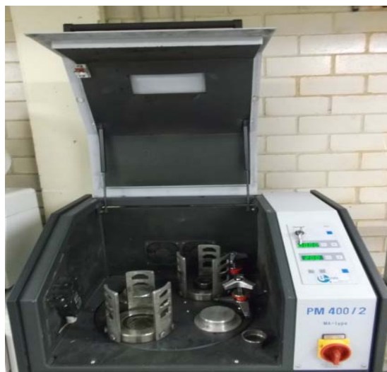
Figure II.2 : Broyeur planétaire type Retsch PM 400/2.
