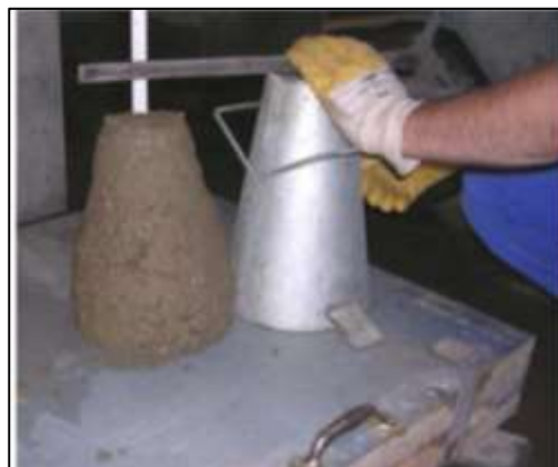
Figure III.8 : Affaissement au cône d'Abrams
