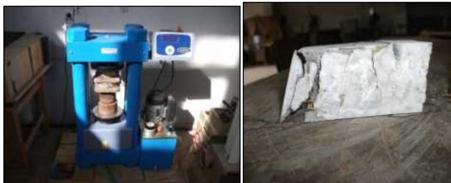
Figure III.3 : Machine d'essai de compression
