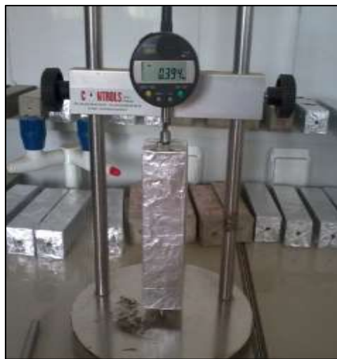
Figure III.6: Dispositif de mesure de retrait en mode endogène pour Éprouvette de 4x4x16 cm
