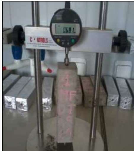
Figure III.7 : Dispositif de mesure des formations de retrait en mode dessiccation pour éprouvette de (4x4x16) cm
