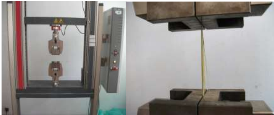
Figure II.18: Montage utilisé pour l'essai de traction directe des fibres
