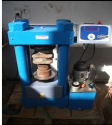
Figure III.9 : Description d'essai de compression
