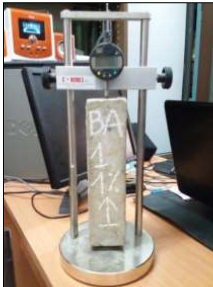
Figure III.11 : Dispositif de mesure de retrait en mode dessiccation pour éprouvette de 7x7x28 cm
