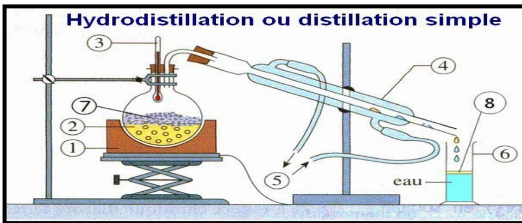
Figure 2 : Schéma du montage de l'extraction par hydrodistillation (Lucchesi., 2005)
