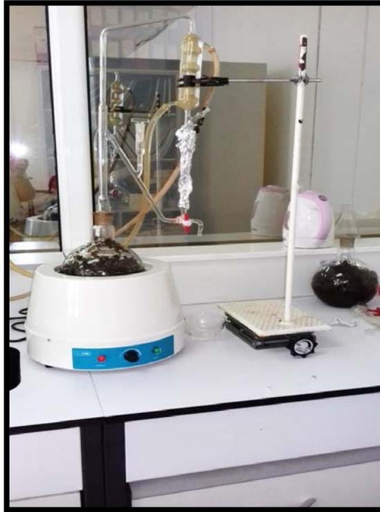
**Figure 15 : Montage de l'hydrodistillateur employé pour l'extraction des huiles essentielles.**
