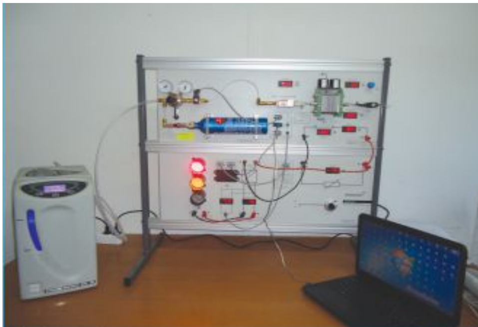
Figure. 3.10 : Système de production d'hydrogène photovoltaïque.
