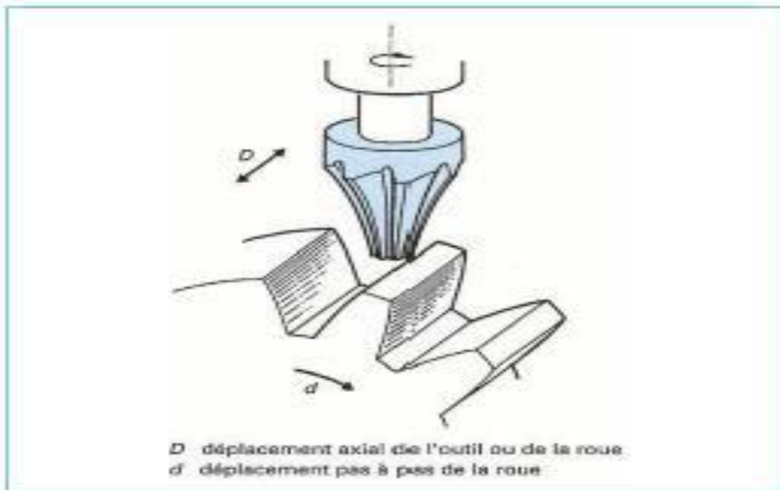
Figure II-27 : Taillage à la fraise en bout [34].
