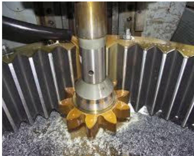
Figure II-25 : Taillage par reproduction [34]
