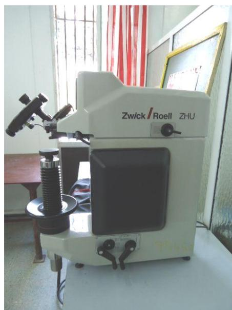
Figure 2.9 – Illustration de la machine d'essai de dureté type : « Zwick/Roll Zhu».
