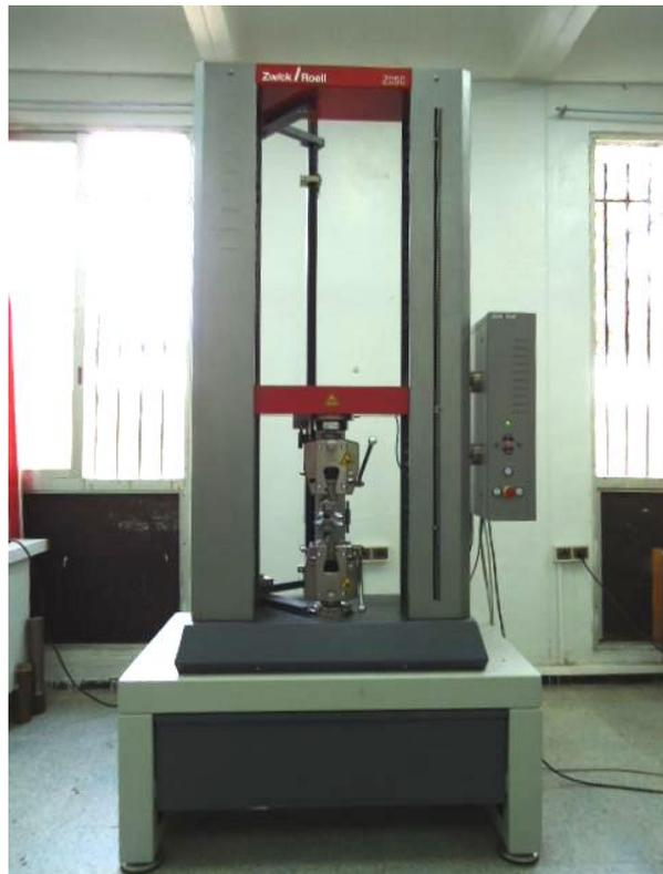
Figure 2.4 –Illustration de la machine de traction type : « Zwick/Roell Z050 ».
