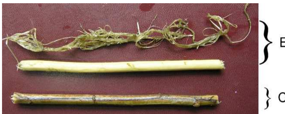
Figure 12: Rouissage du chanvre ( Crotalaria juncea ) sous l'action d'une pectine lyase de l'espèce Aspergillus flavus MTCC 7589. après traitement enzymatique (E) en comparaison avec le témoin (C) Control (Yadav et al., 2009).
