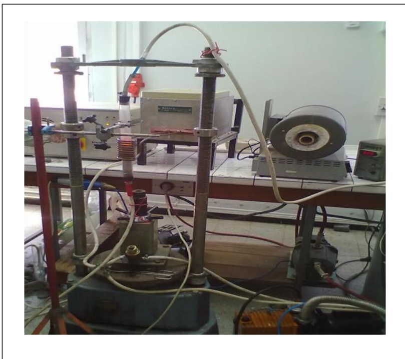
Figure 2.2 : Photo du montage expérimental utilisé pour l'élaboration des alliages TiNi
