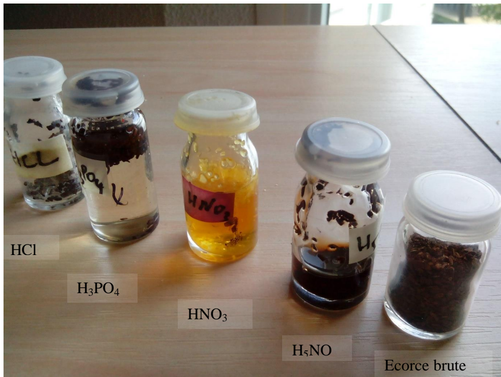
Figure IV.6: Réaction de l'écorce avec différents agents chimiques.
