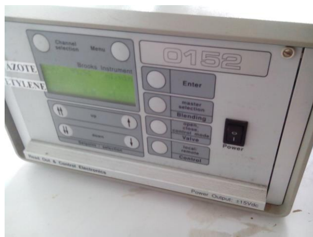
Figure IV.4 : Régulateur de débit du gaz inerte.
