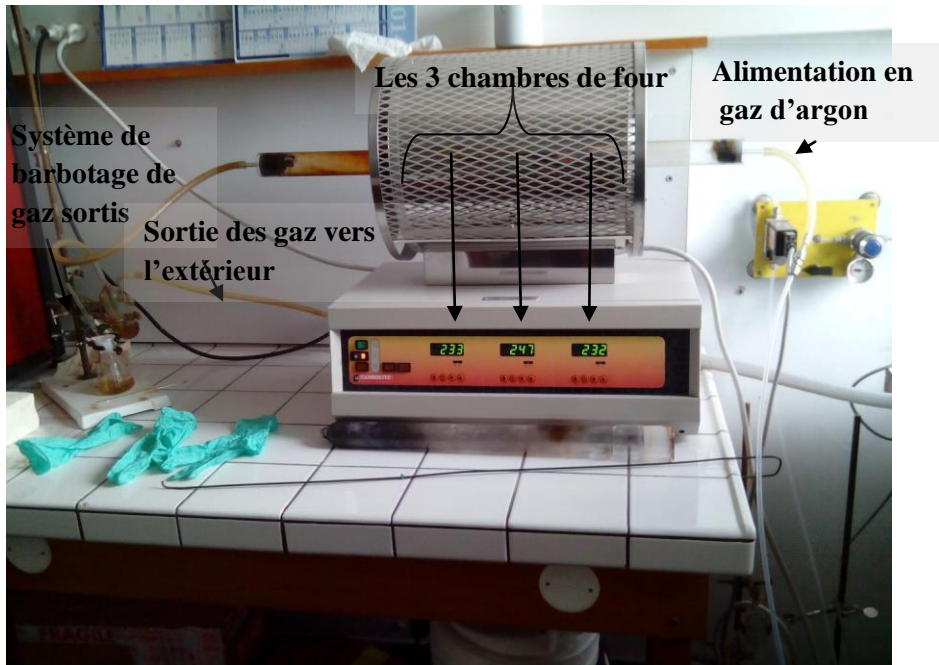
Figure IV.3 : Circulation du gaz inerte.
