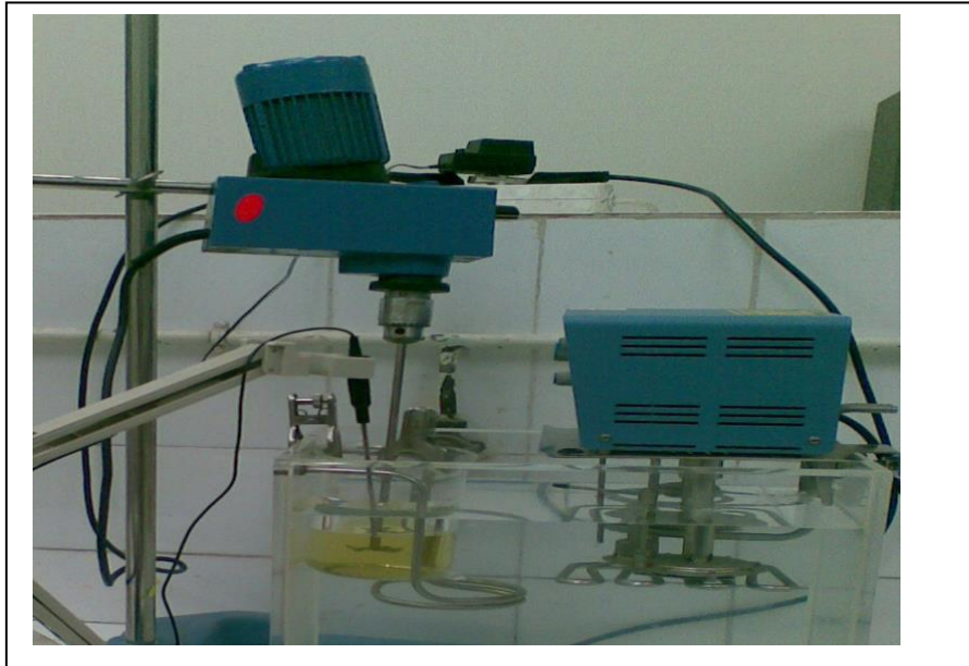
Figure II.2 : Schéma expérimental de la biosorption en mode statique
