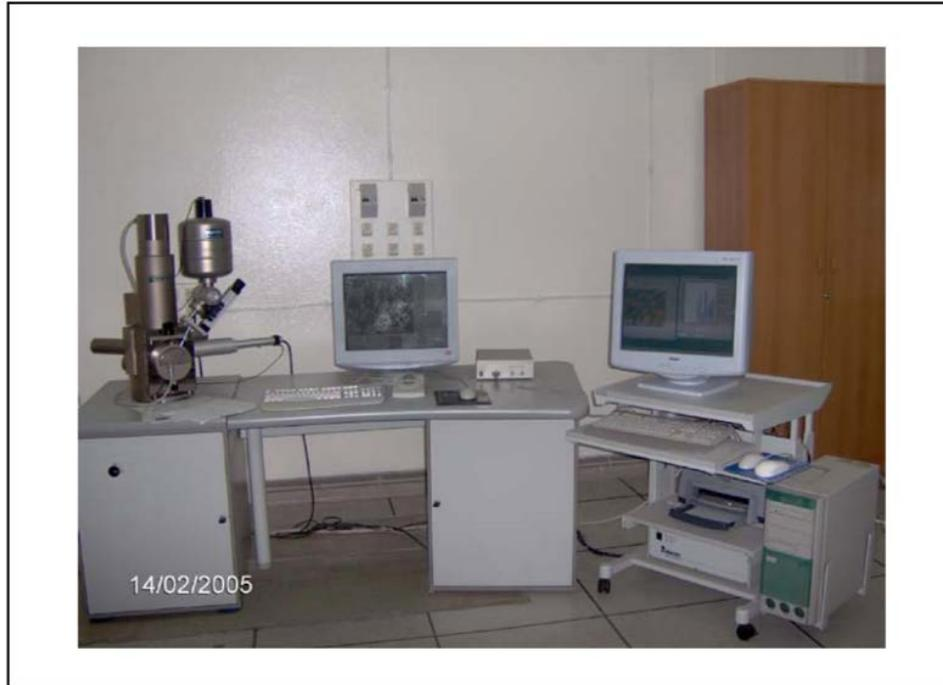
**Figure (II.9) :** Photo d'un microscope électronique à balayage (MEB).
