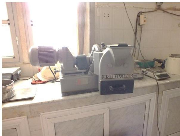
**Broyeur pulvérisateur (Model SIEBTECHNIK)**
