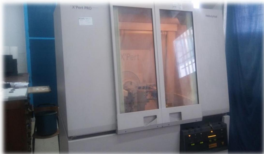
**Figure III.10 : appareil d'analyse par diffraction des rayons X, DRX** (Université El-Manar, Tunis)
