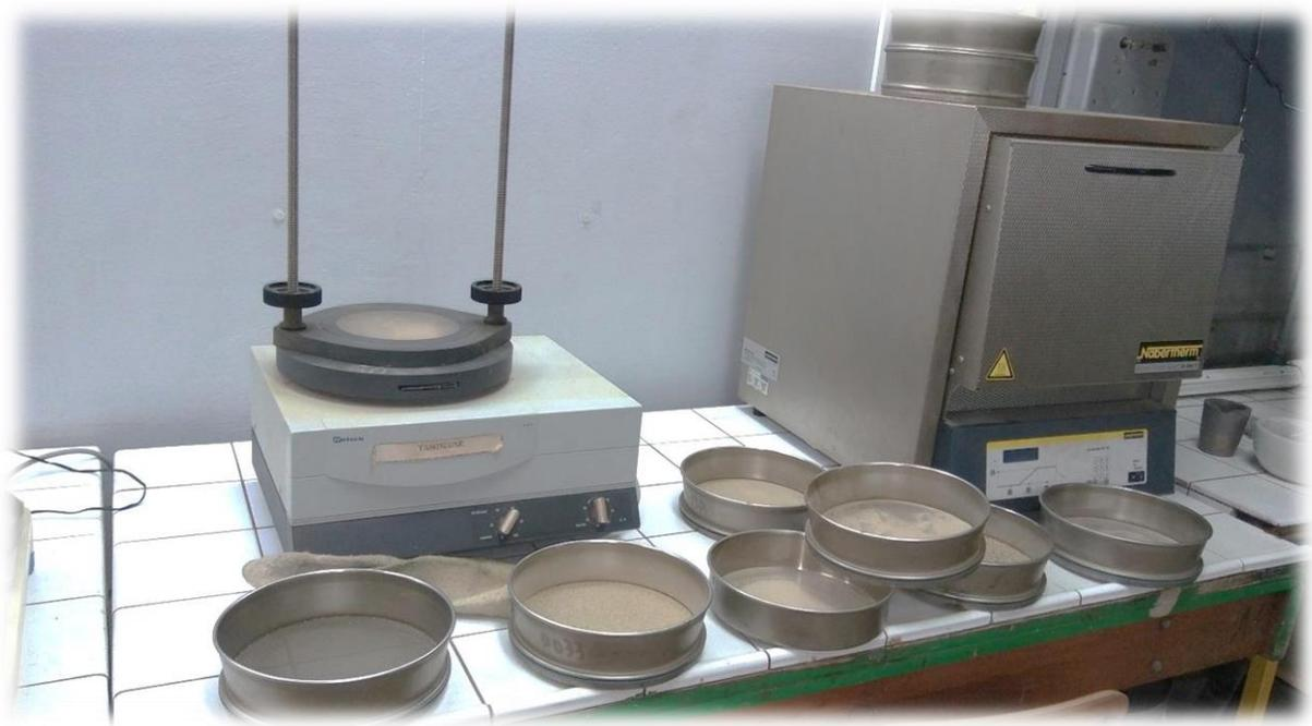
**Figure III.6 : Tamiseuse pour les analyses granulométriques (LAVAMINE)**
