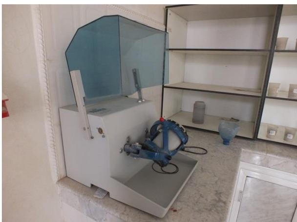
**Mélangeur homogénéisateur (Model TURBULA)**
