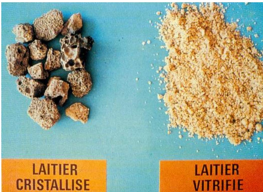
*Figure I.2 : le laitier de haut fourneau, Rocheux et Granulé (source : [www.millenniummultitrade.com](http://www.millenniummultitrade.com))*
