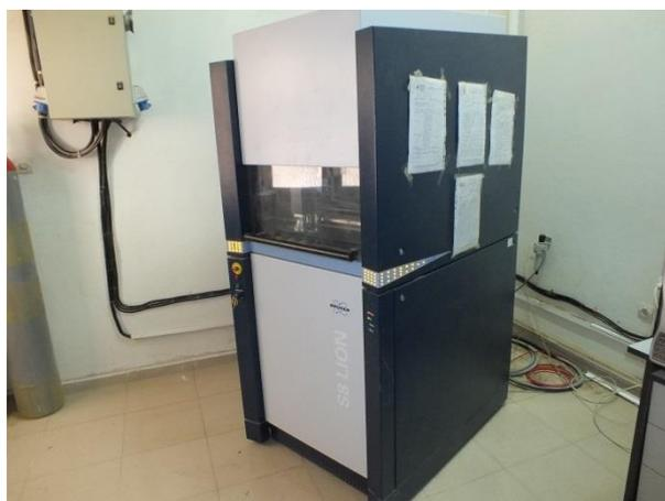
**Diffractomètre FRX (Model BRUKER)**
