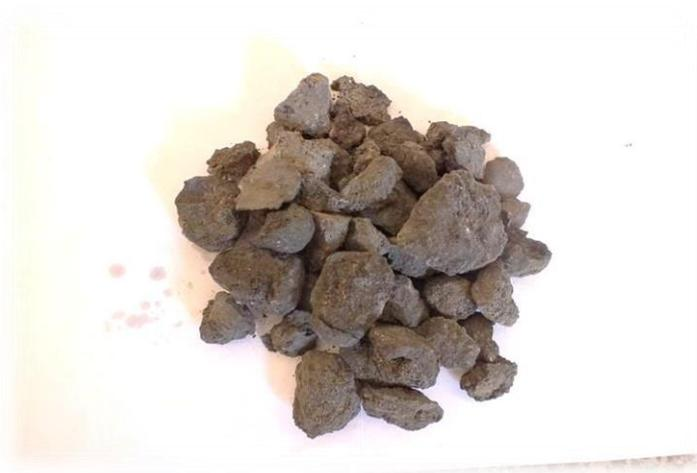
**Figure III.15 : Clinker à base de laitier obtenu expérimentalement**
