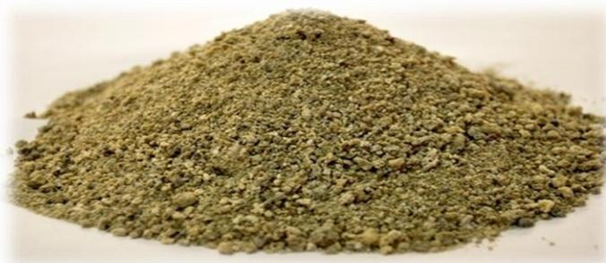
**Figure III.4 : Le laitier granulé vitrifié de haut fourneau de HADJAR SOUD**
