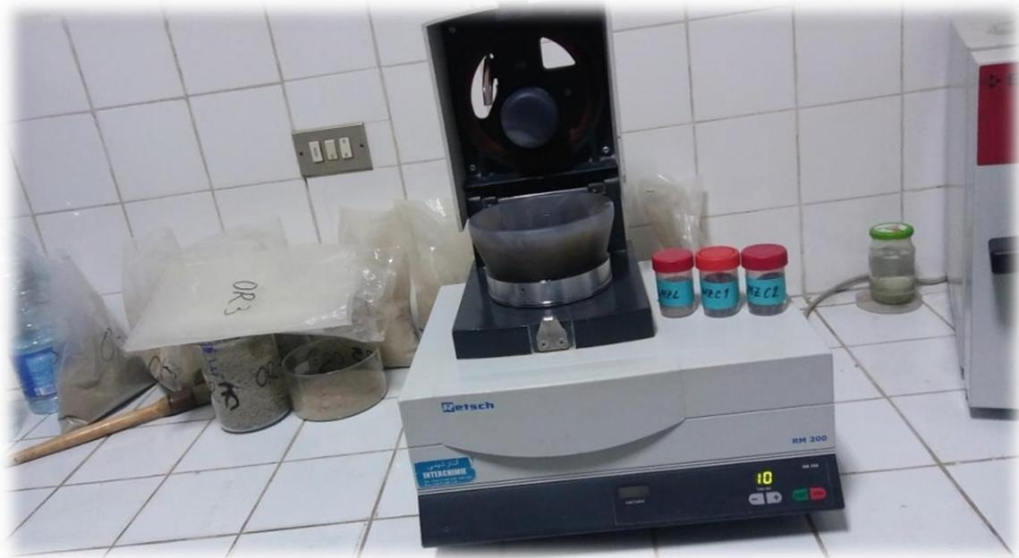
**Figure III.9 : Agate mécanique pour la préparation des échantillons à l'analyse par DRX**
