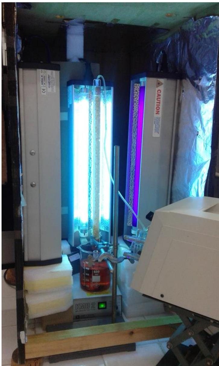
**Figure IV.1.** Réacteur photocatalytique tubulaire à base des films du  $\text{TiO}_2$  P25 déposés sur des anneaux de Raschig et utilisé pour l'élimination du méthyl orange en mode continu.
