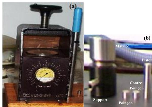
Figure III. 3 : (a) presse uniaxiale, (b) matrice
