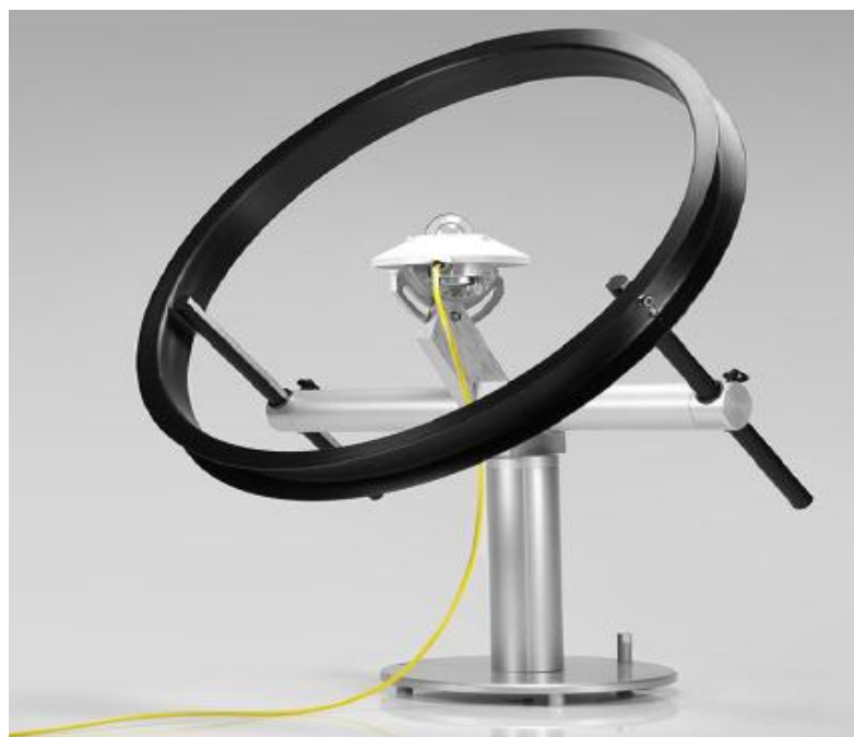
Figure I.10 Le pyranomètre ombré mesure du rayonnement diffus [14]
