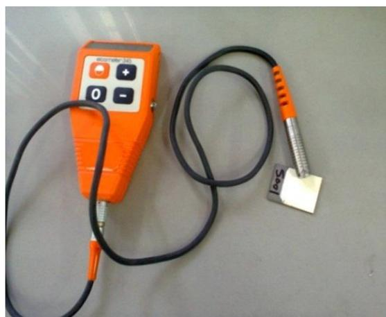
Figure II.17. Contrôleur d'épaisseur type Elcometer 345.
