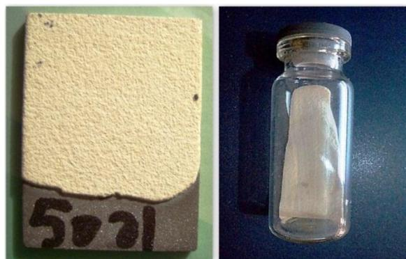
Figure II.16. Echantillon massif et poudre pour l'analyse par DRX.
