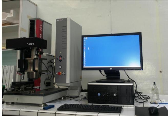
Figure II.23. Microduromètre instrumenté Zwick.
