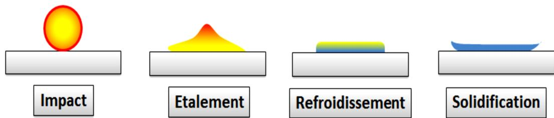
Figure I.29. Mécanisme schématique de l'étalement d'une lamelle <sup>106</sup>.
