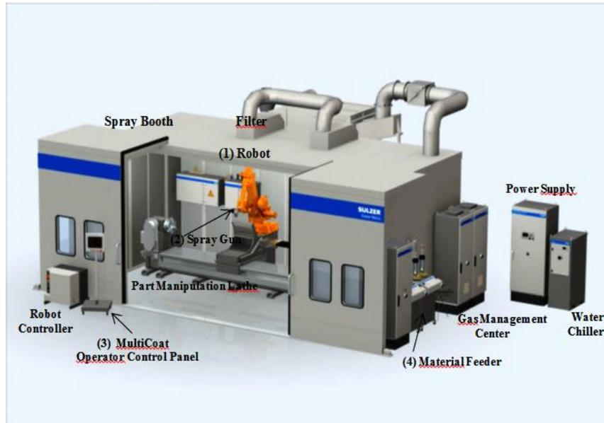
Figure II.4. Photographie et schéma de l'APS.
