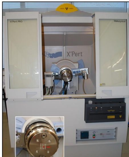
Figure III.2 : Diffractomètre de type Philips X Pert
