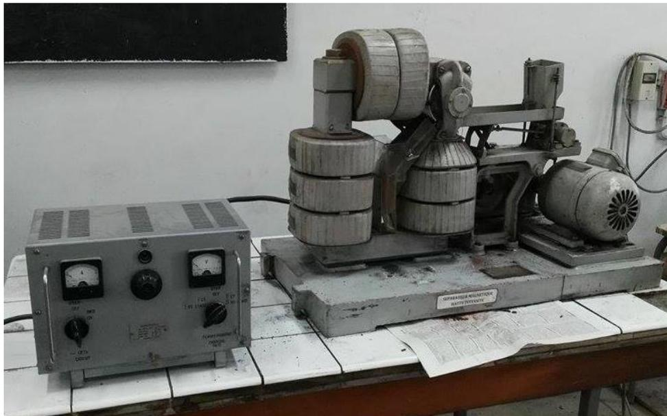
Figure 49. Séparateur magnétique à haute intensité en voie sèche
