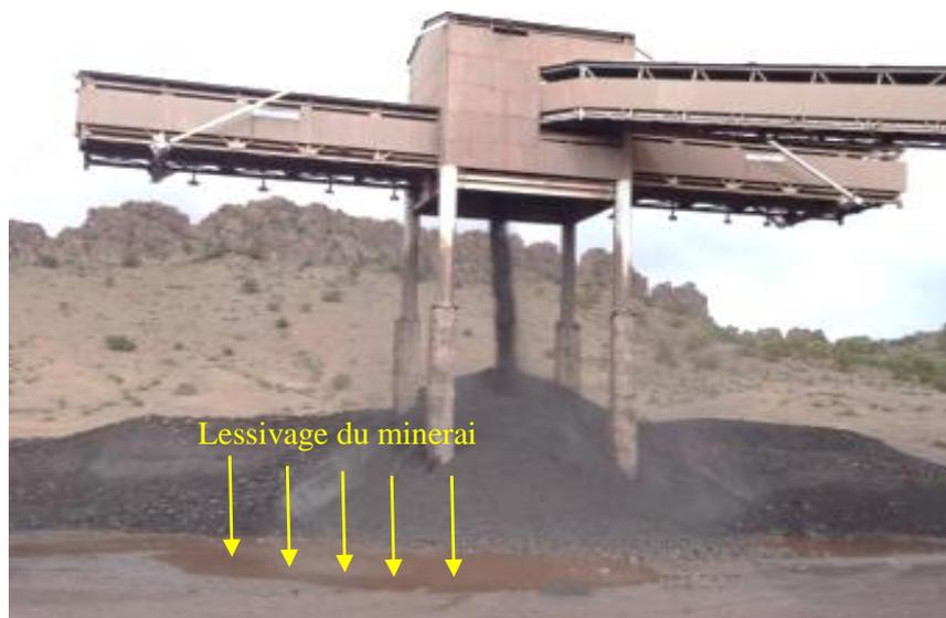
Figure 20. Exemple sur le phénomène de lessivage du minerai de fer de Boukhadra à la sortie de concasseur (CNTTP, 2014).
