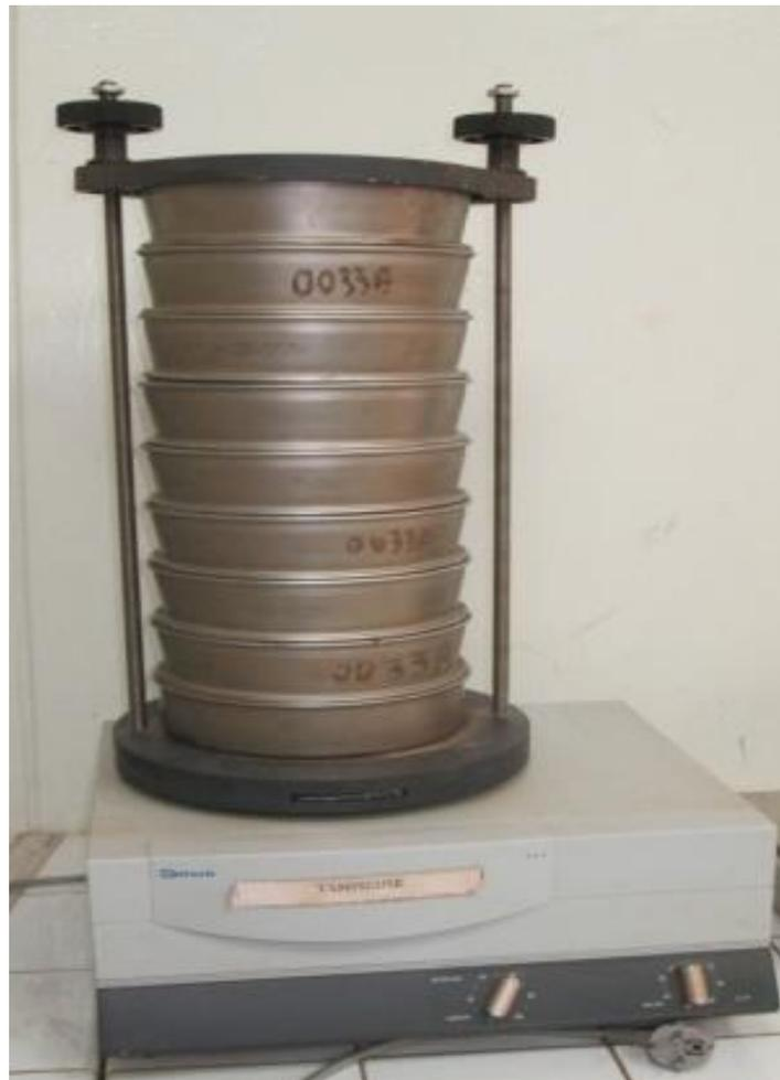
Figure 33. Tamiseuse électrique de type RITSH
