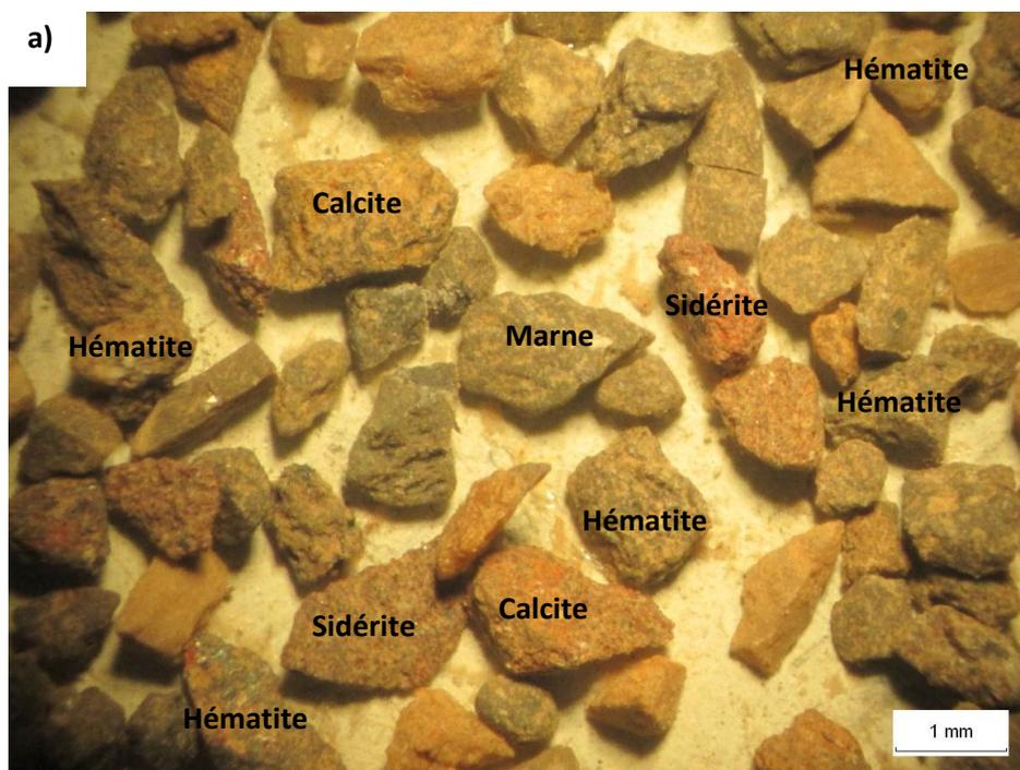
Figure 37. Vue à la loupe binoculaire de la classe -1 + 0,5 mm
