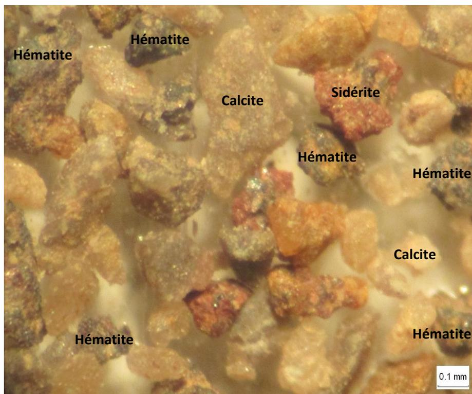
Figure 39. Vue à la loupe binoculaire de la classe -0,25 + 0,125 mm
