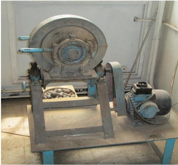
Figure v. Broyeur à boulet
