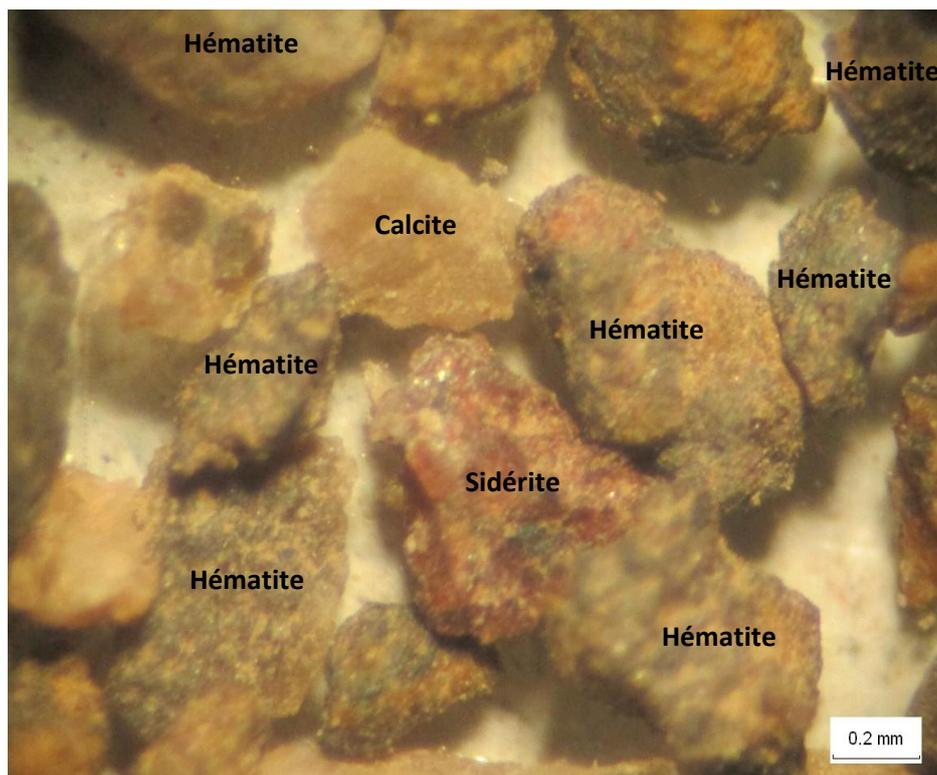
Figure 38. Vue à la loupe binoculaire de la classe -0,5 + 0,25 mm
