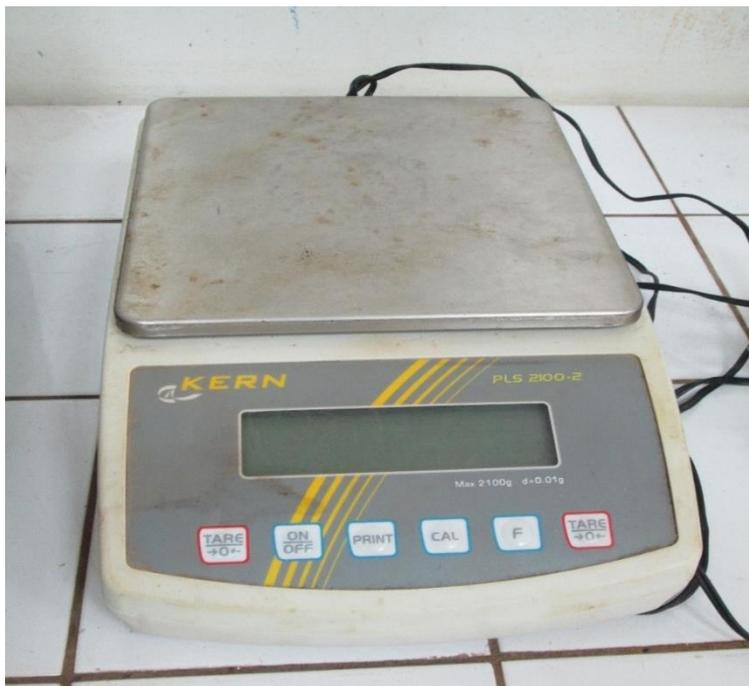
Figure vi. Balance électronique
