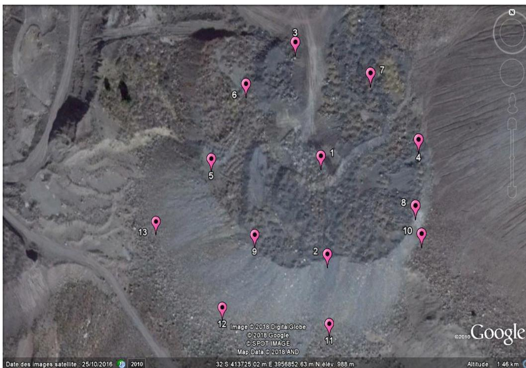
Figure 23. Points de prélèvement des échantillons des stériles francs de la mine de Boukhadra
