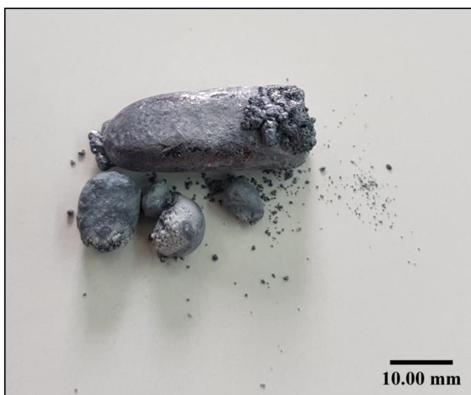
Figure IV-21 : Photographie de l'échantillon Co-Si
