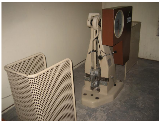
Figure II.12. Machine utilisée pour les essais de résilience
