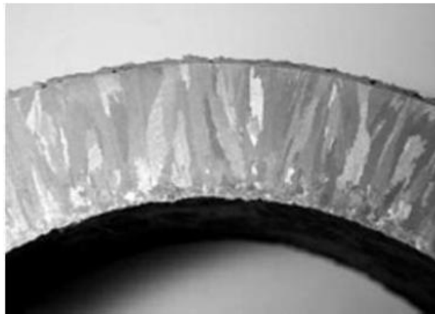
Figure I.11. Macrostructure montrant les grains équiaxes et colonnaires [42]
