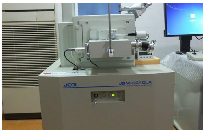
Figure II.5. MEB «JEOL JSM-6610LA» utilisé pour les essais métallographiques
