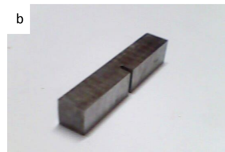
Figure II.11 : a. Dimensions de l'éprouvette de résilience, b. Eprouvette de résilience utilisée
