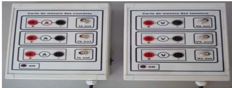
FigV.8: Capteurs de tension et de courant
