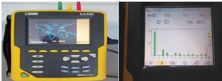
FigV.7 : Analyseur de la qualité d'énergie électrique (Qualistar CA 8336)
