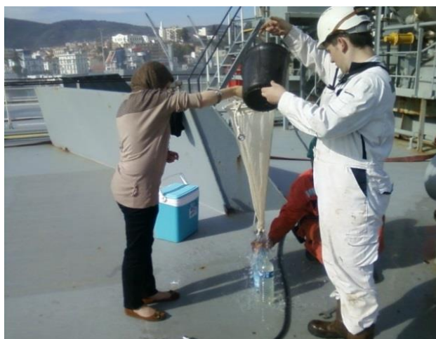
Figure 06. Prélèvement d'eau de ballast pour l'analyse des organismes.
