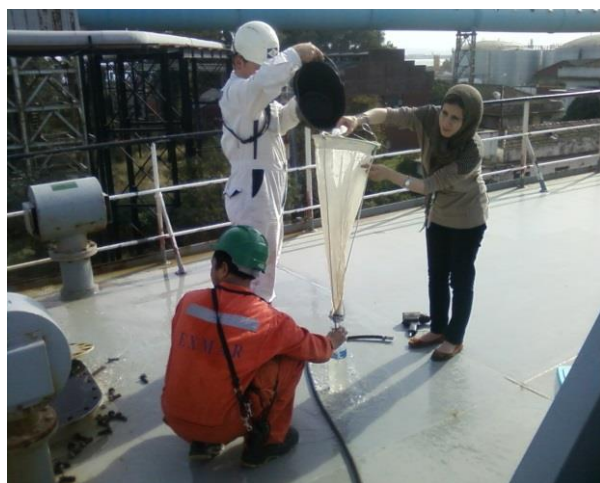
Figure 06. Prélèvement d'eau de ballast pour l'analyse des organismes.
