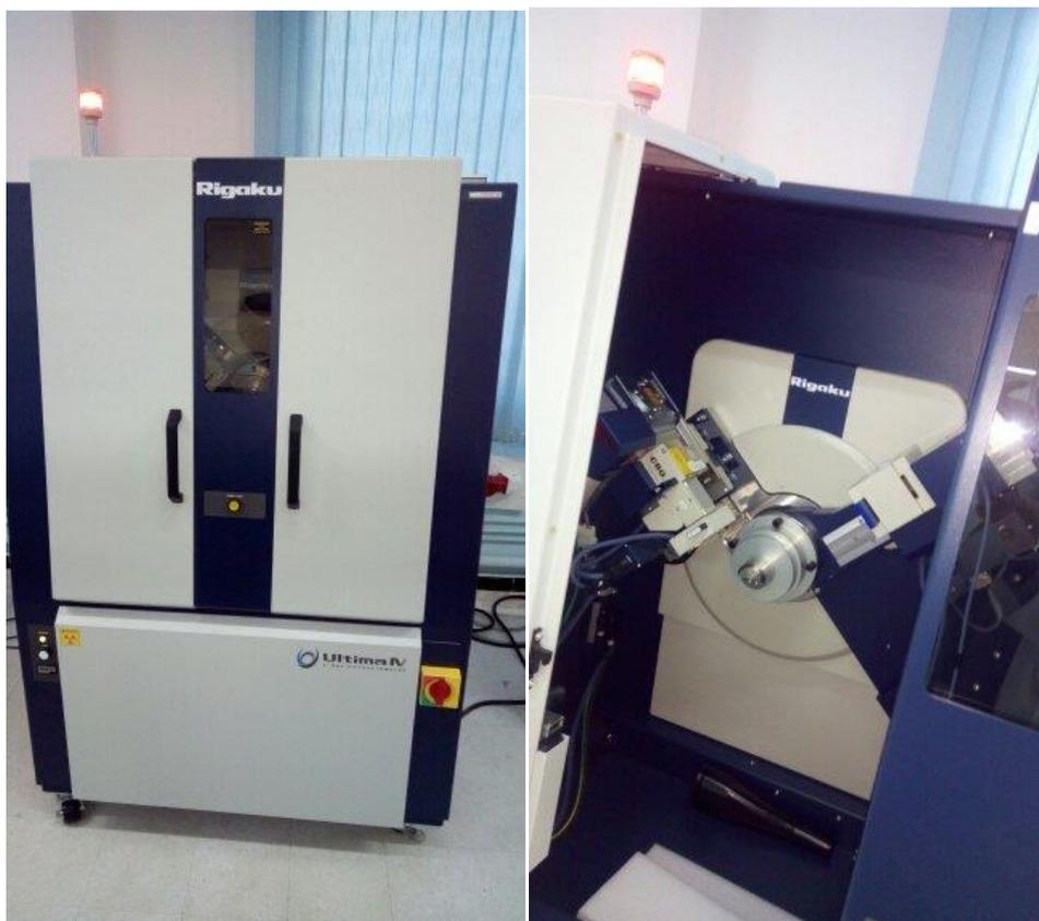
**Figure 27:** Diffractomètre RIGAKU
