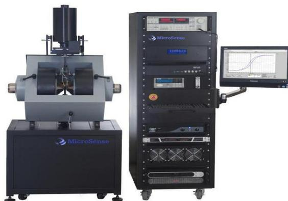
**Figure 23** : Magnétomètre à échantillon vibrant de Microsense VSM
