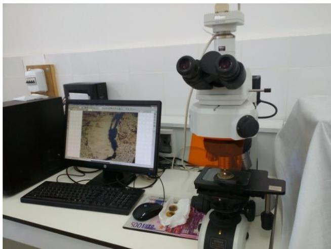
**Figure 18** : Microscope optique Nikon- Eclipse-LV100ND
