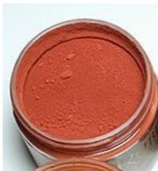
Figure 2: Poudre d'hématite Fe<sub>2</sub>O<sub>3</sub> [10].
