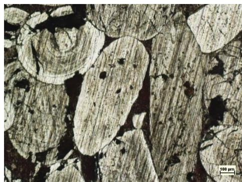
**Figure 43** : Oolithes avec  $\text{Fe}_3\text{O}_4$  entourés de  $\text{Fe}_2\text{O}_3$  et de gangue siliceuse (X 50).
