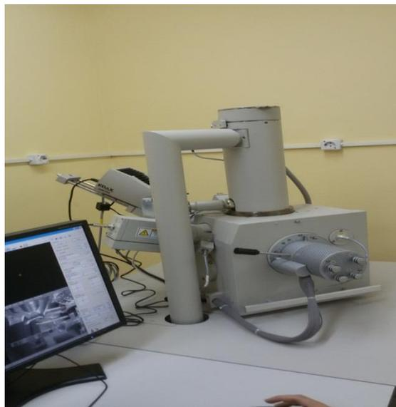
**Figure 26** : Microscope électronique à balayage Quanta 250
