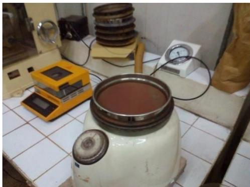
**Figure 20** : Tamis à jet d'air
