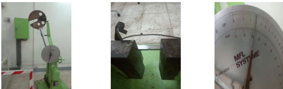
Fig. II.25. Déroulement de l'essai de résilience
