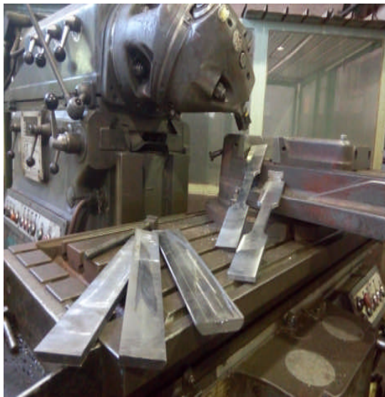
Fig. II.17. Fraisage des éprouvettes.
