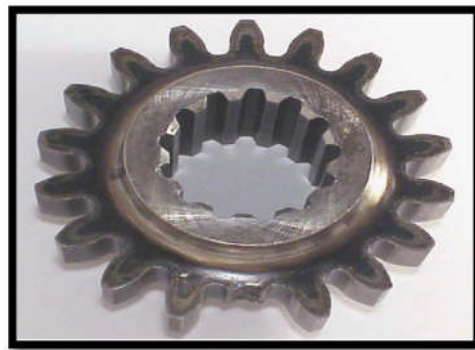
Fig. I.23. Photo du pignon droit examinée dans un appareillage de puissance-circulation d'essai de fatigue d'engrenage jusqu'à la rupture de dent.
