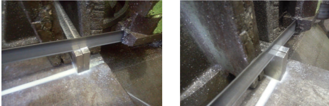
Fig. II.23. Coupe des éprouvettes sur scie mécanique
