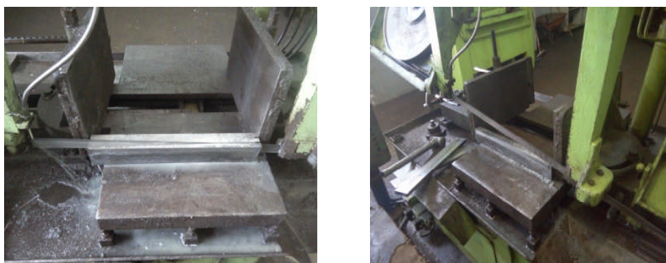
Fig. II.16. Coupe des éprouvettes sur Scie mécanique
