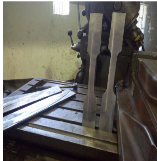
Fig. II.17. Fraisage des éprouvettes.
