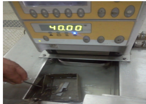
Fig. II. 26. Essai de résilience à 40 °C
