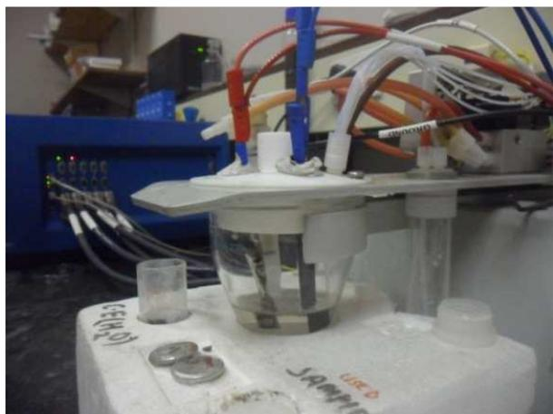
Figure III.17: Cellule électrochimique du potentiostat : Bio-logic VMP-300
