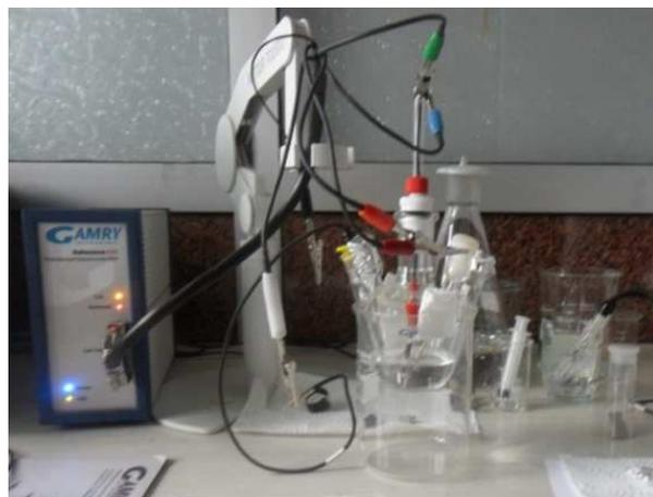
Figure III.18: Cellule électrochimique du potentiostat : Gamry600
