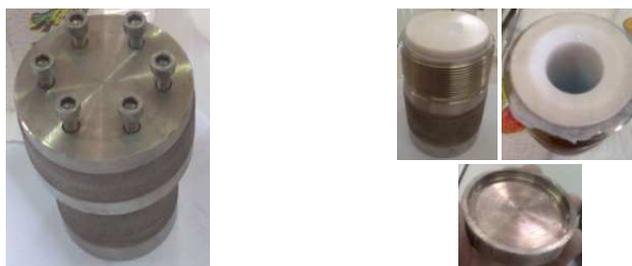
Figure III.3: Photos d'un autoclave en acier inoxydable et l'enceinte intérieure en Teflon
