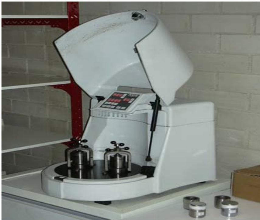
Figure II.7 : Broyeur planétaire de type Frisch P7
