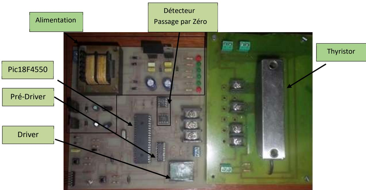
Figure 47- Modules de commande et de puissance du redresseur monophasé réalisé
