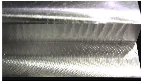
(b) présence du phénomène de broutement
