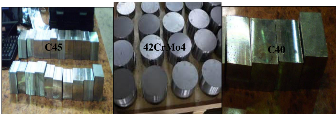
Figure III.3 : Eprouvettes d'essai en acier C45, 42CrMo4 et C40.
