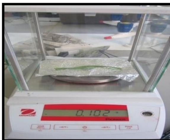
**Fig.16** : Mesure du poids de la matière fraîche
