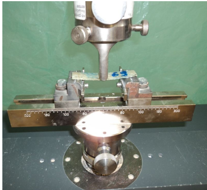
Figure 2.7. Dispositif d'essai de flexion 3 points.
