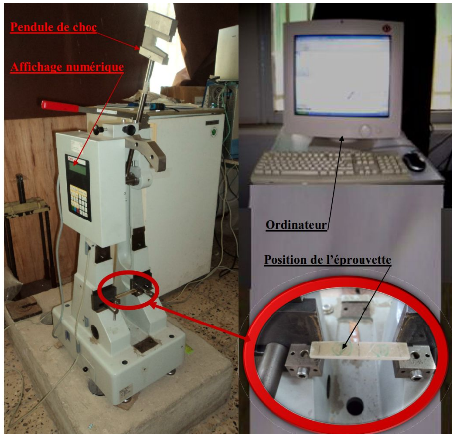
Figure 2.13. Machine d'essai Charpy avec affichage numérique.
