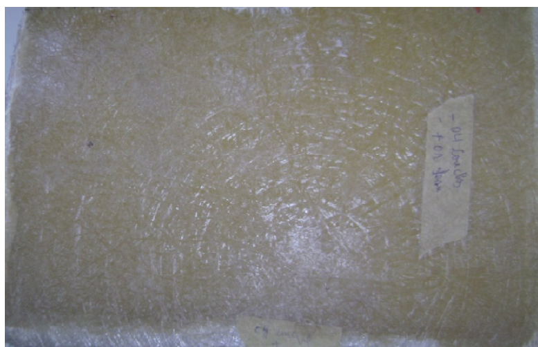
Figure 2.2. Plaque en composite multidirectionnel verre polyester 40% (VP40)
