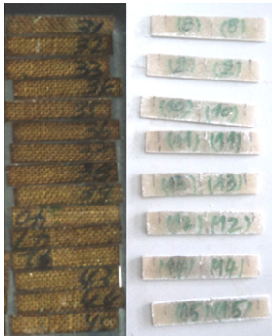
Figure.2.9. Éprouvette utilisée en fatigue
