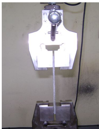
Figure 2.5. Dispositif d'essai de traction.
