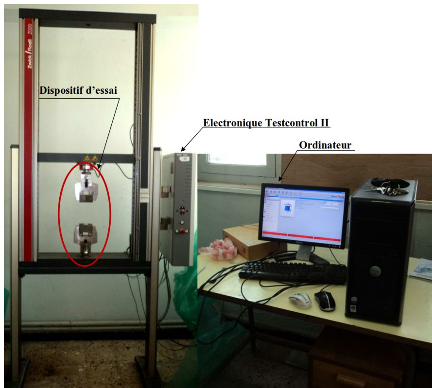
Figure 2.4. Machine de flexion universelle (Zwick Z020).
