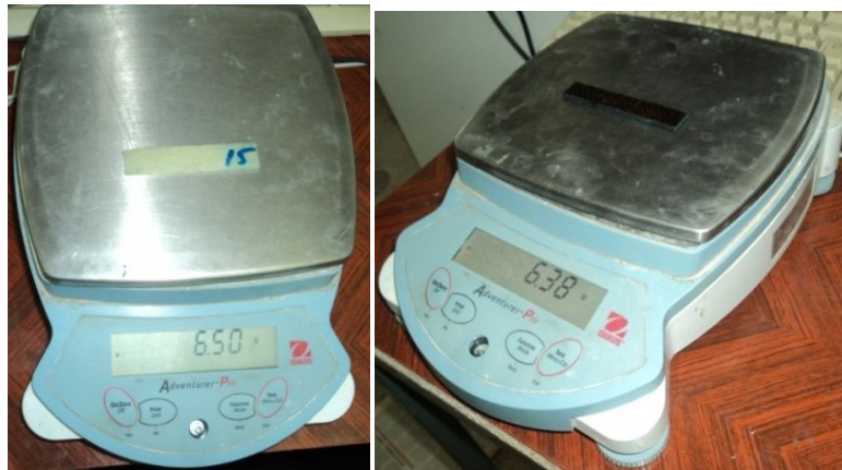
Figure 2. 15. Éprouvettes pesées par une balance OHAUS Adventurer Pro AV8101.
