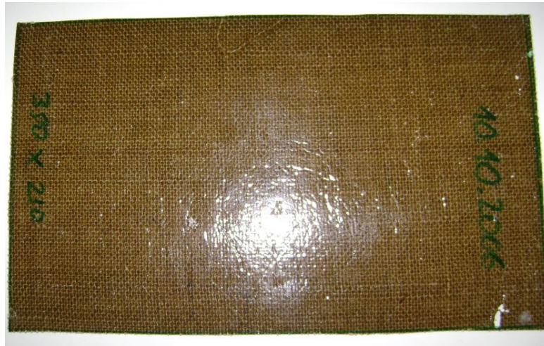
Figure 2.1. Plaque en composite bidirectionnel jute polyester 40% (JP40)
