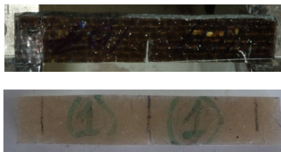
Figure 2.12. Éprouvettes utilisées aux essais de choc Charpy.
