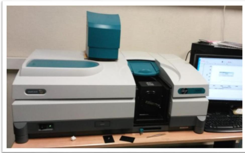
Figure III.18 : Spectrophotomètre Cary 5000.
