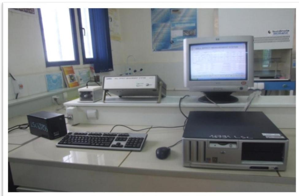
Figure III.24 : Banc de mesure d'effet Hall (HMS 3000).
