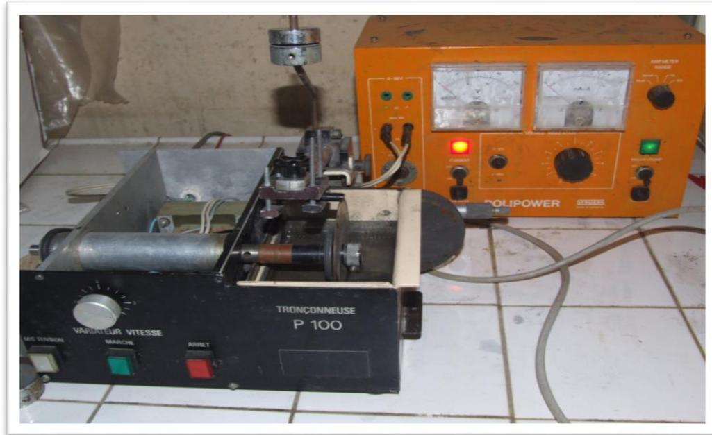
*Figure III.11 : Opération de découpe des lingots par la tronçonneuse.*
