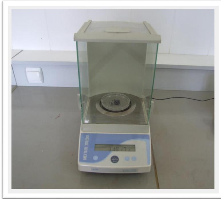
Figure III.4: Balance électronique, utilisée pour le pesage des éléments
