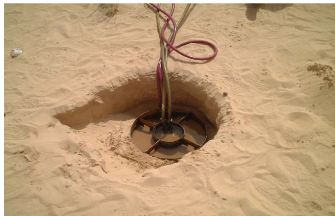
Figure 62 : Infiltromètre Muntz pour une mesure de coefficient de perméabilité K .
