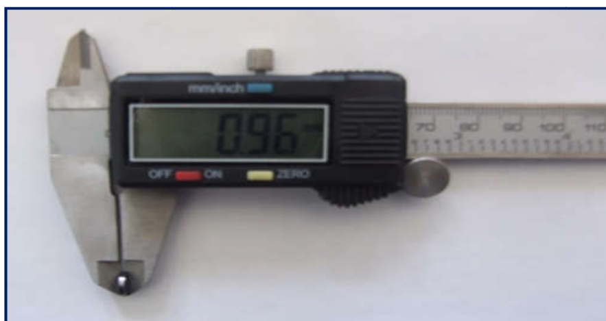
Figure III.15 : Mesure de l'épaisseur de la pastille de CuInSe 2 .
