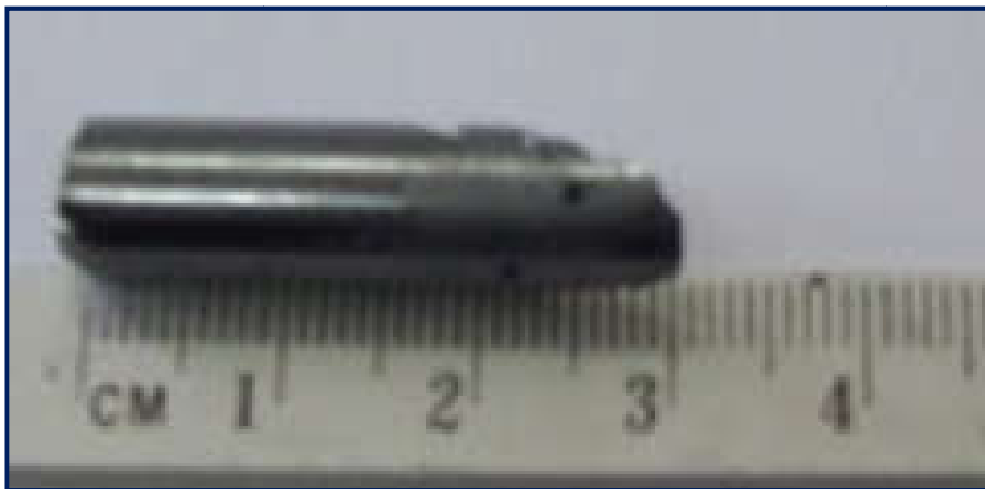
Figure III.7 : Image du lingot CIS élaboré après son extraction du tube en quartz.
