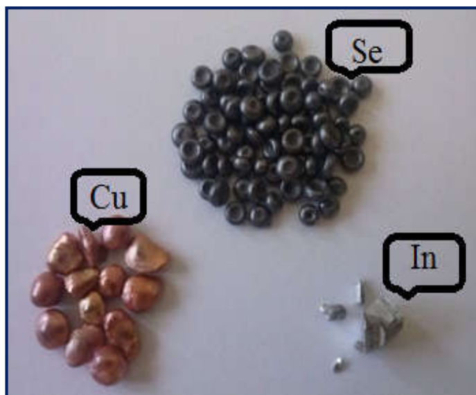
Figure III.2 : Images réelles des précurseurs (Cu, In, Se 2 ) utilisés.
