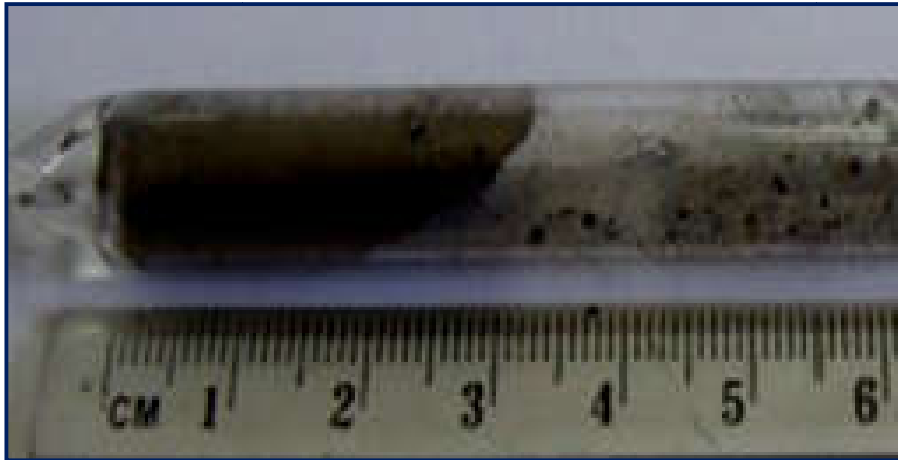
Figure III.6 : Image du lingot CIS élaboré avant son extraction du tube en quartz.
