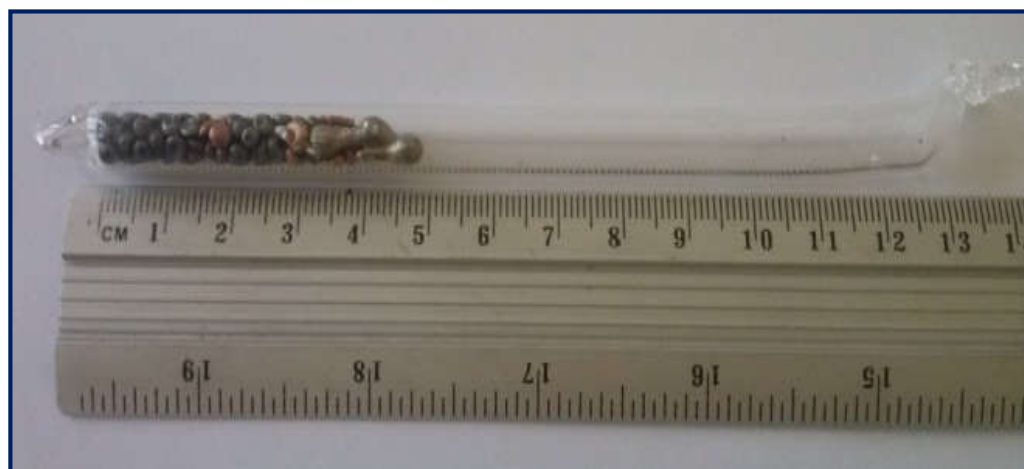
Figure III.4 : Tube chargé par le mélange des éléments.
