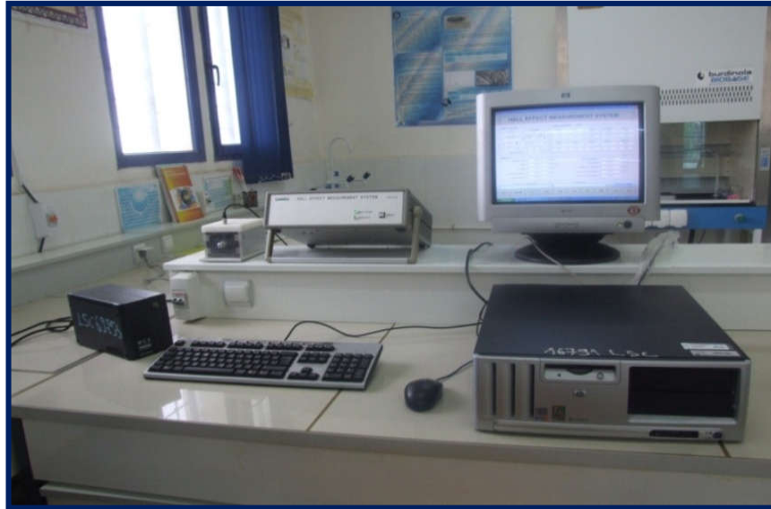
Figure III.17 : Banc de mesure d'effet Hall (HMS 3000).
