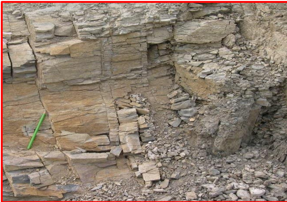
Photo 7. Marne dégradée (photo prise pendant les études de l'avant-projet détaillé dans la section étudiée. Source : ANA, 2007)
