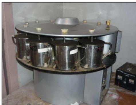
**Figure 15** : Mise des cassettes dans l'appareil de déshydratation des gonades de *Sparus aurata*
