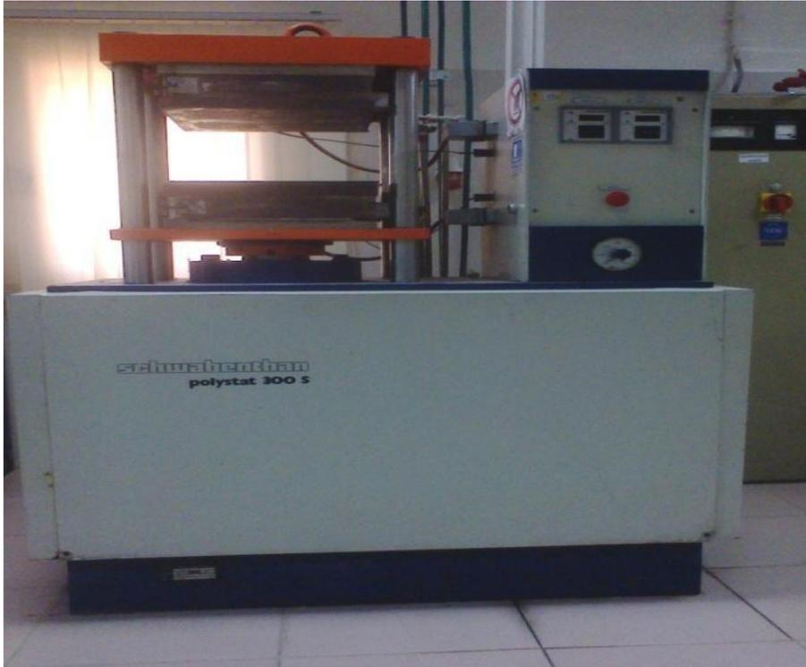
Figure IV.2. Vue de la presse utilisée pour la fabrication des plaques du PRC
