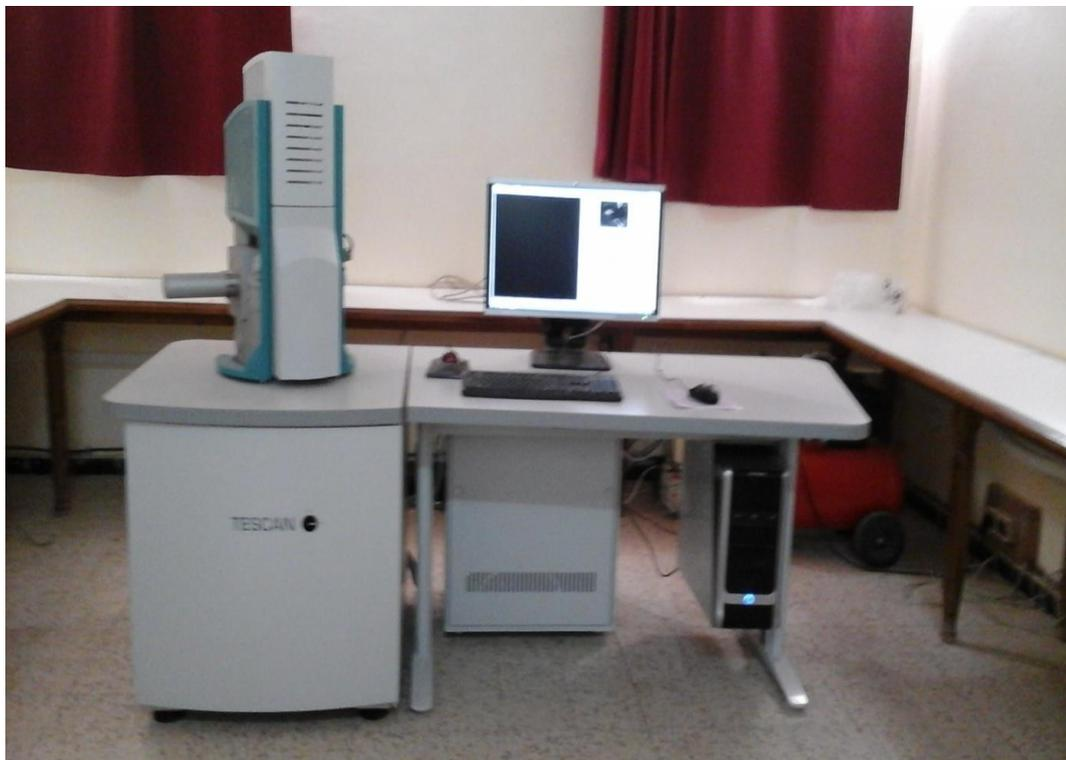
Figure IV.9. Photographie du microscope électronique à balayage
