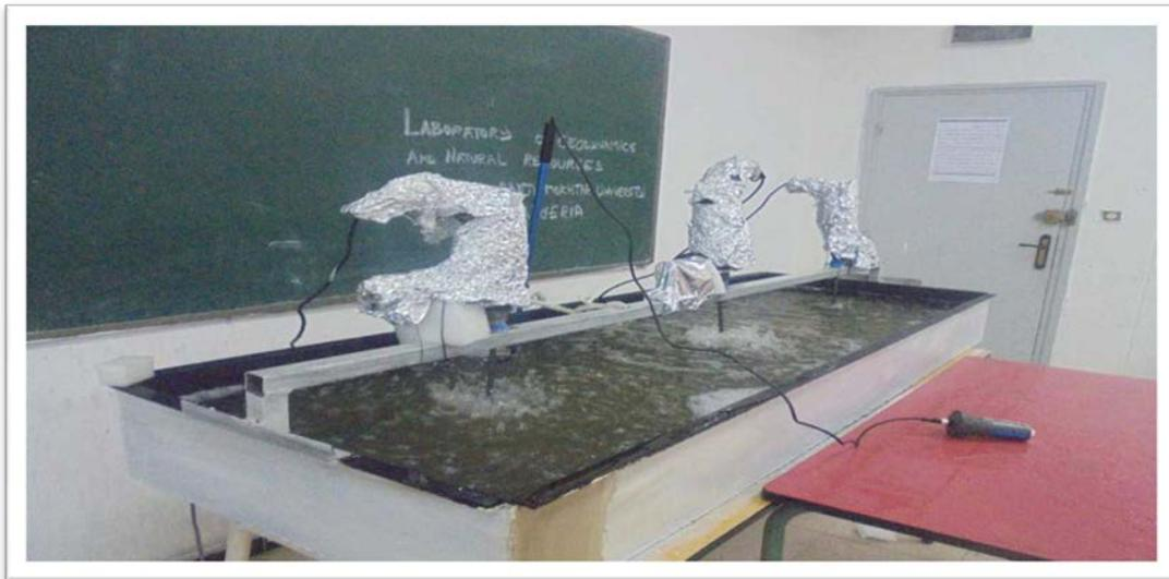
*Photo .6 Modèle réduit du bassin d'aération à l'échelle 1/33*
