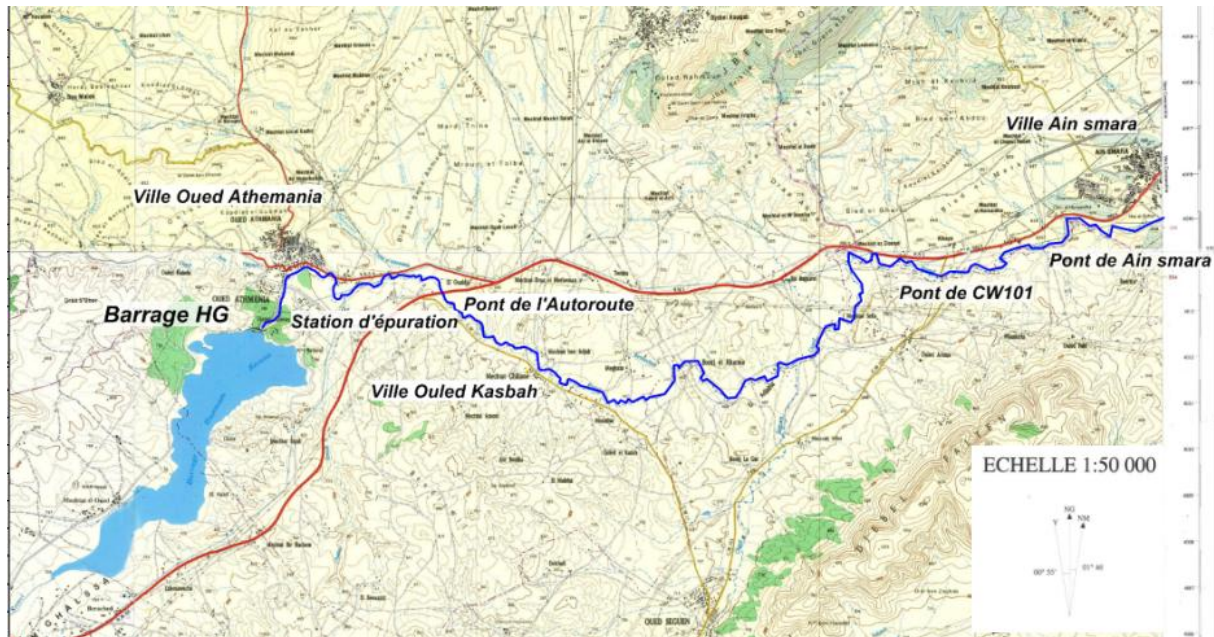
Figure 2-6 : Ouvrages éventuellement menacés à l'aval du barrage
