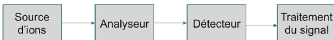
Figure 6. Étapes de la spectrométrie de masse ( Suarez., 2013 ).
